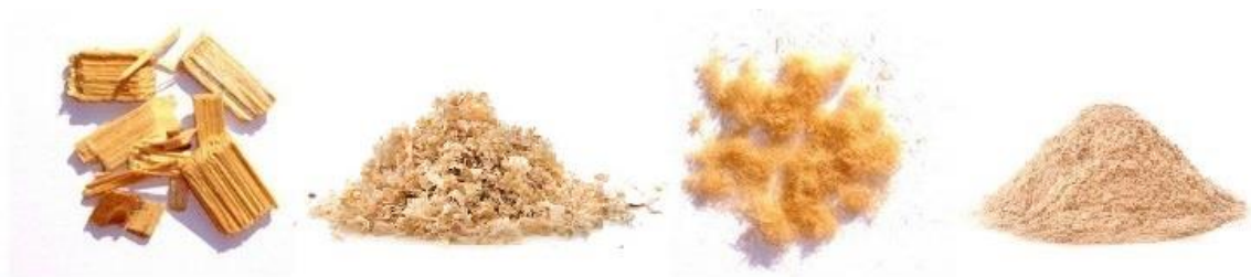
Obr. 7 Formy dřevních částic (WoodflourMill 2019) (Zleva: dřevní štěpka, dřevní piliny, dřevní vlákna, dřevní moučka)
