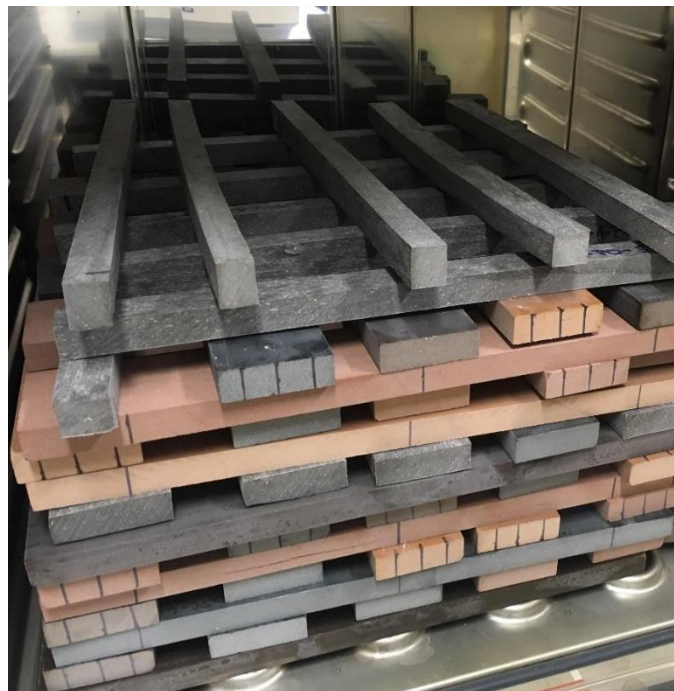
Obr. 25 Rozložení vzorků v horkovzdušné sušící komoře (Autor)
