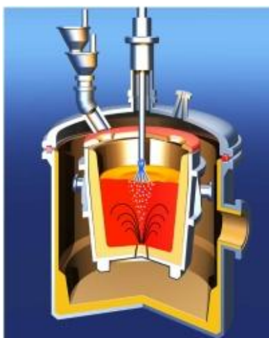
Obr. 2.3 Princip metody VOD [13]
