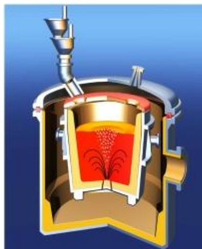
Obr. 2.2 Princip metody VD [12]
