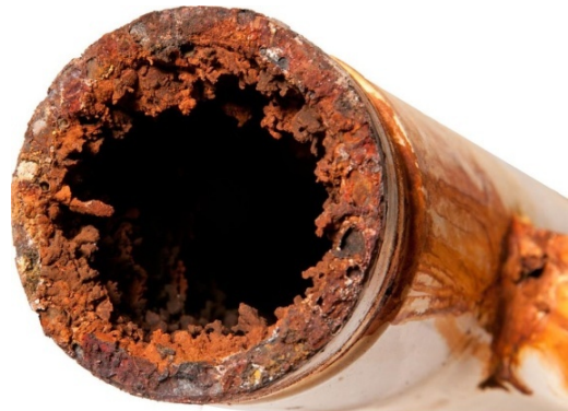
Obrázok 9: Železité usadeniny v potrubí [9]
