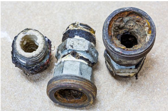
Obrázok 8: Dôsledok inkrustácie na armatúrach [8]
