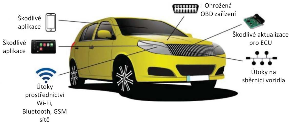
Obrázek 8: Možné způsoby elektronického napadení vozidla
