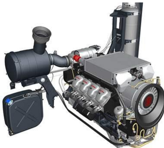
Obrázek 4.5 Motor Tatra T3D-928 Euro5 s SCR (Vokáč, 2008)
