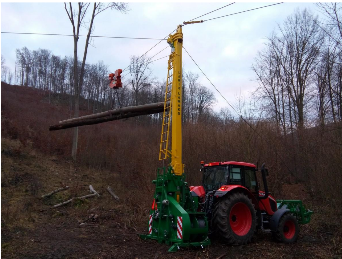
Obr. 10 Larix Lamako v agregaci s traktorem Zetor Forterra HD 140 [20]
