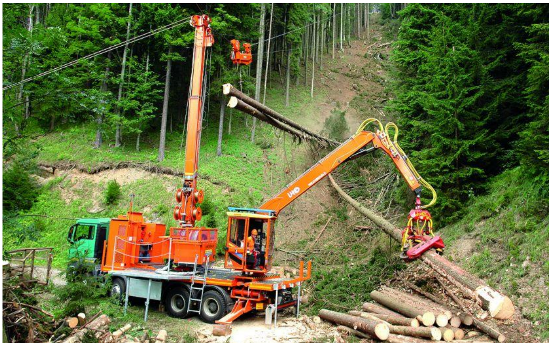
Obr. 1 Zařízení Syncrofalke s jeřábem vybaveným procesorovou hlavici [24]
