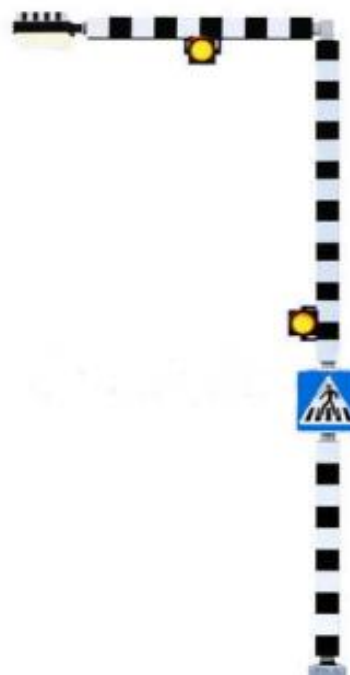
Obr. č. 33 – Osvětlení přechodu pro chodce (20)
