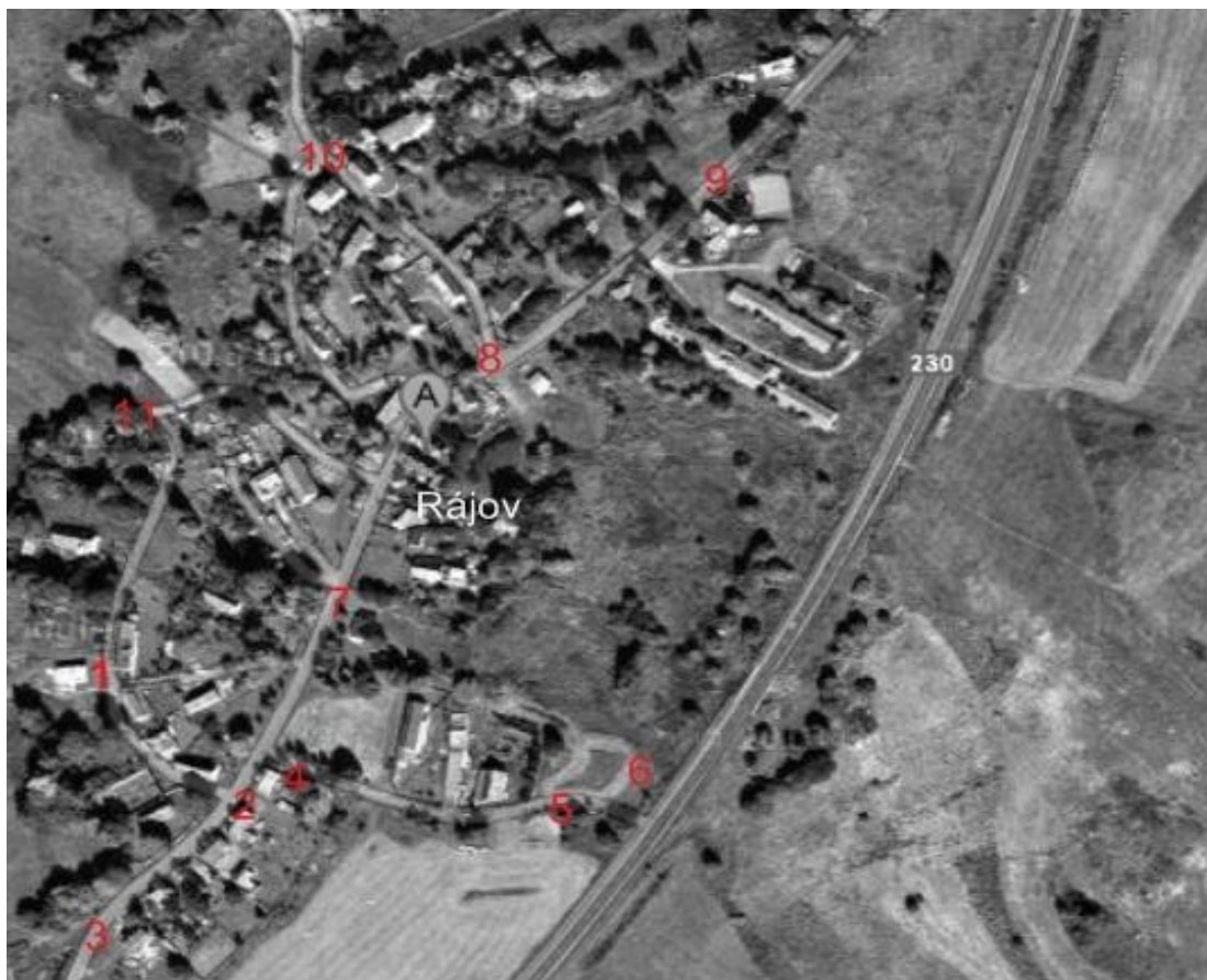
Obrázek č. 34: Zaměření polohy a výšky určených míst v obci Rájov – situace pro zbudování gravitační kanalizace
