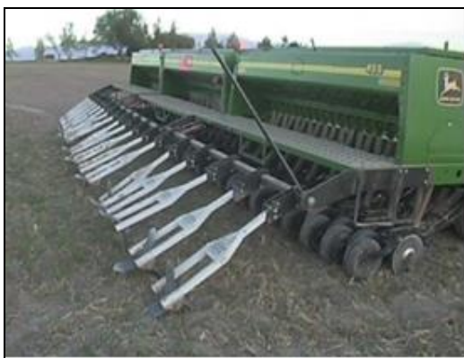
Obr. č. 15, 16: Důlkovací zařízení přímo na secím stroji a stav pozemku po výsevu (Zdroj: Dvořák).
