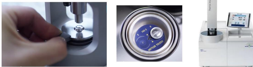
Obr. 72 Zařízení DSC 1 STAR SYSTÉM [53]
