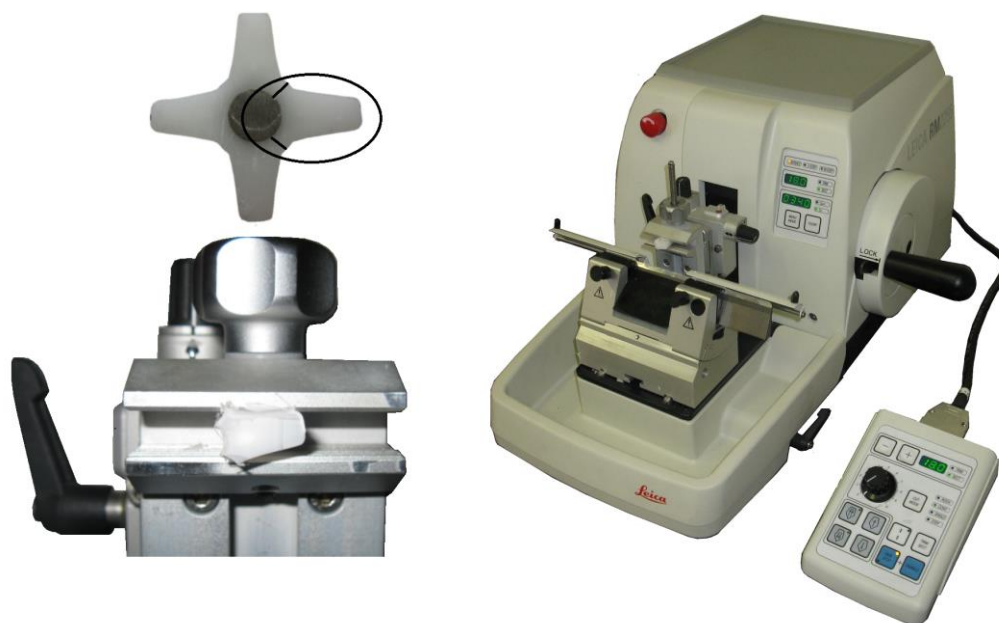
Obr. 77 Příprava mikrotomových řezů na zařízení Leica RM 2155
