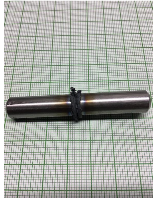
Fig. 45 AISI 316L final weld
