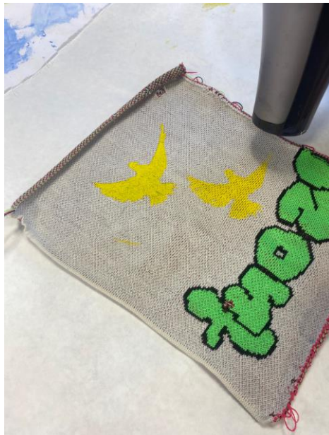
Obrázek 9 První zkoušky sítotisku s termochromickým pigmentem na pletenině
