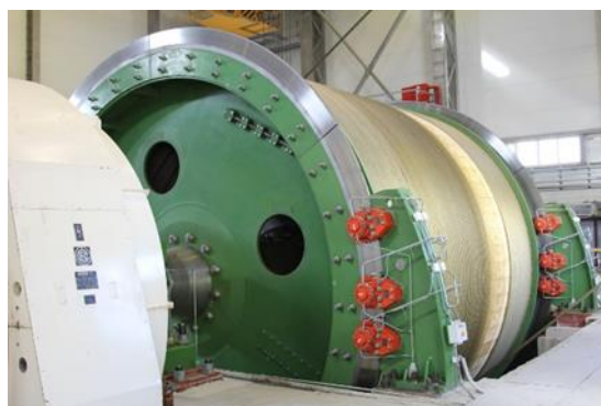
Obrázek 4 Dvoububnový těžní stroj
