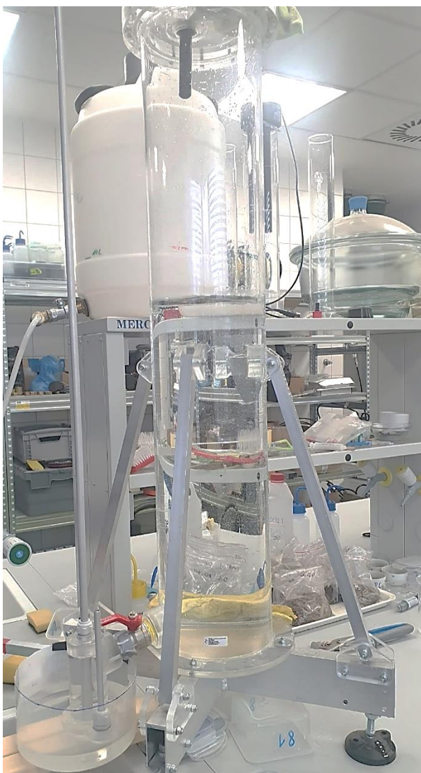
Obrázek 21: Umístění barologgeru do vika zásobníku na vodu u prvního prototypu.
