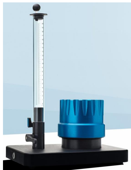
Obrázek 9: Laboratorní permeametr – automatický laboratorní systém pro měření K_s (převzato ekotechnika.cz).
