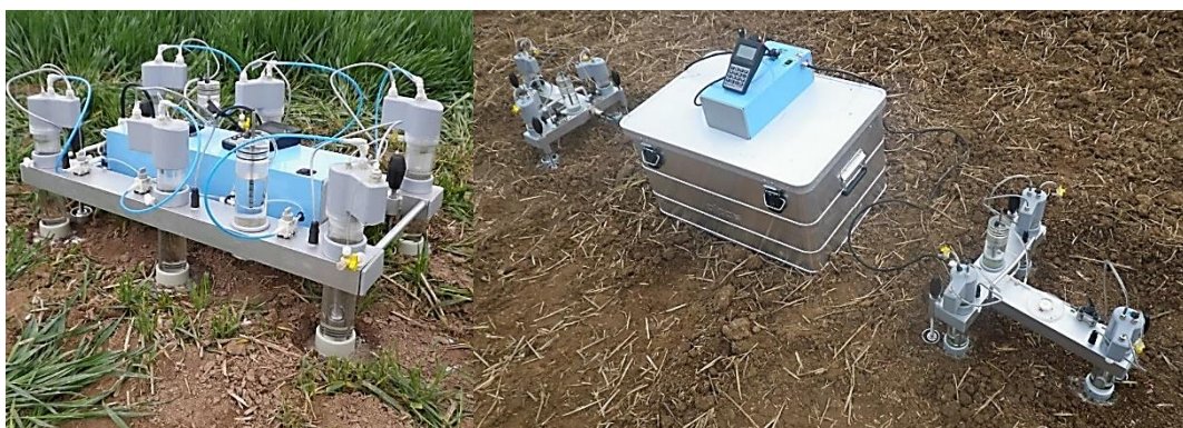
Obrázek 12: První prototyp AMI se šesti podtlakovými infiltračními moduly (vlevo) a druhý prototyp AMI rozdělený na dvě samostatné části připojené k datastanici kabelem (vpravo). Oba prototypy obsahují tři infiltrační moduly na jednu Mariottovu láhev (převzato a upraveno Klípa et al. 2014).
