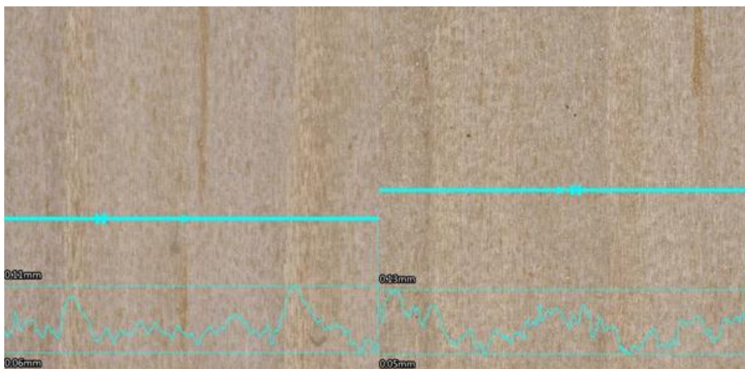
Obrázek 22: Mikroskopické snímky povrchu strojně opracovaných vzorků, na levé straně před nátěrem kožním kličem a na pravé straně po nátěru kožním kličem. Fotografie jsou proloženy profilem jejich drsnosti.
