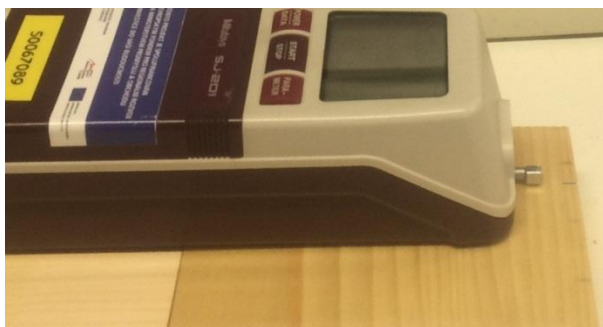
Obrázek 12: Ukázka měření drsnosti povrchu drsnoměrem v příčném směru (foto autora)
