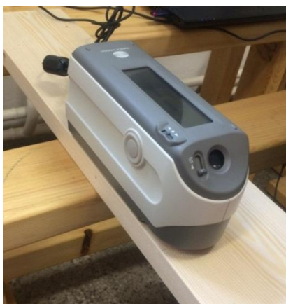
Obrázek 16: Ukázka měření barvy vzorku pomocí přístroje KONICA MINOLTA CM-2300d (foto autora)
