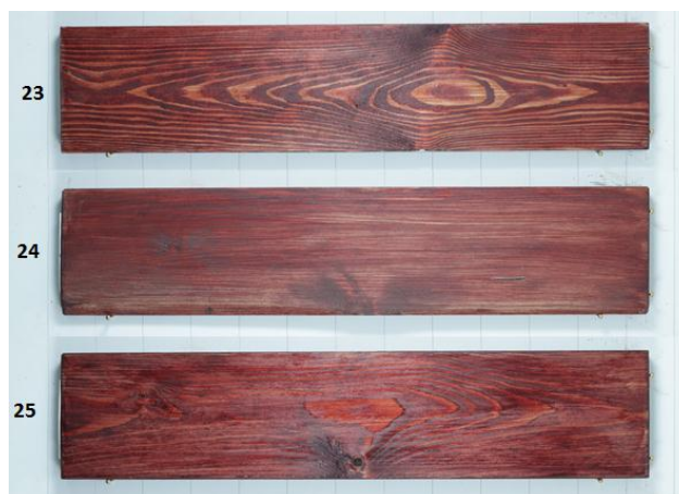
Obrázek 25: Snímky barvy povrchu vzorků natřených různými recepturami po jednom týdnu od druhého nátěru. (foto autora)
