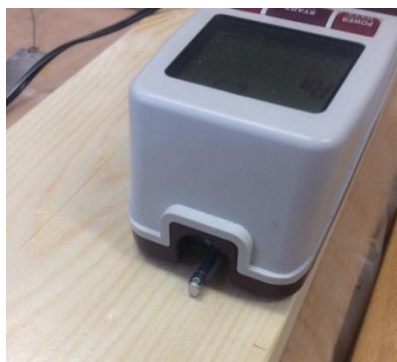
Obrázek 13: Ukázka měření drsnosti povrchu drsnoměrem v podélném směru (foto autora)
