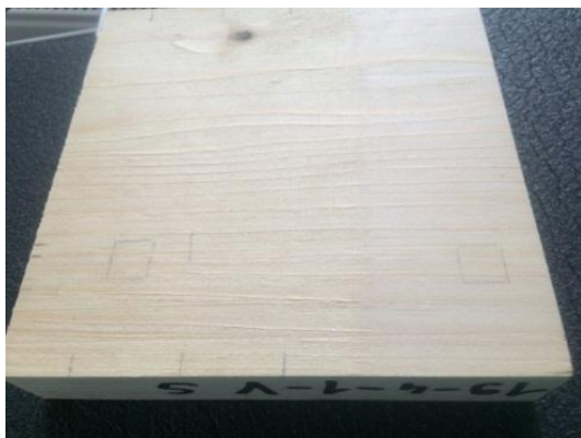
Obrázek 14: Fotografie vzorku použitého pro měření drsnosti povrchu dřeva v laboratořích Ústavu nábytku, designu a bydlení a pro snímání povrchu pomocí mikroskopu Keyence VHX-5000 (foto autora)
