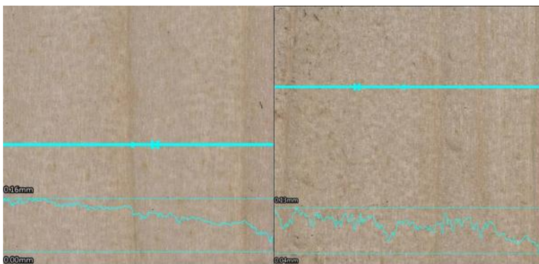
Obrázek 23: Mikroskopické snímky povrchu ručně opracovaných vzorků, na levé straně před nátěrem kožním kličem a na pravé straně po nátěru kožním kličem. Fotografie jsou proloženy profilem jejich drsnosti.
