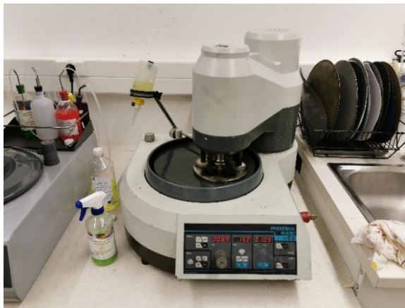
Obr. 3-12 Příprava vzorku pro metalografické pozorování z pístu spalovacího motoru
