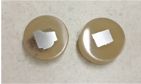
Obr. 3-13 Metalografické vzorky pro pozorování na světelném mikroskopu
