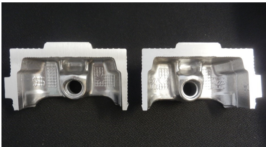
Obr. 3-9 Půlky pístu ze slitiny KS 1275 (AlSi12Ni Mg)
