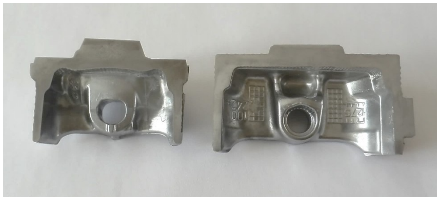
Obr. 3-10 Naleptaná struktura obou polovin pístů spalovacích motorů
