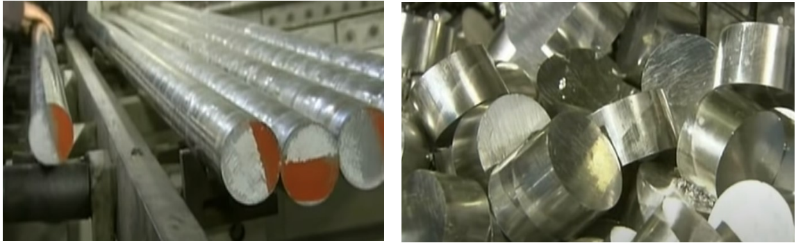
Obr. 2-11 Válcové polotovary slitin hliníku (vlevo) a nařezané polotovary hliníkové slitiny připravené k ohřevu (vpravo) [14]
