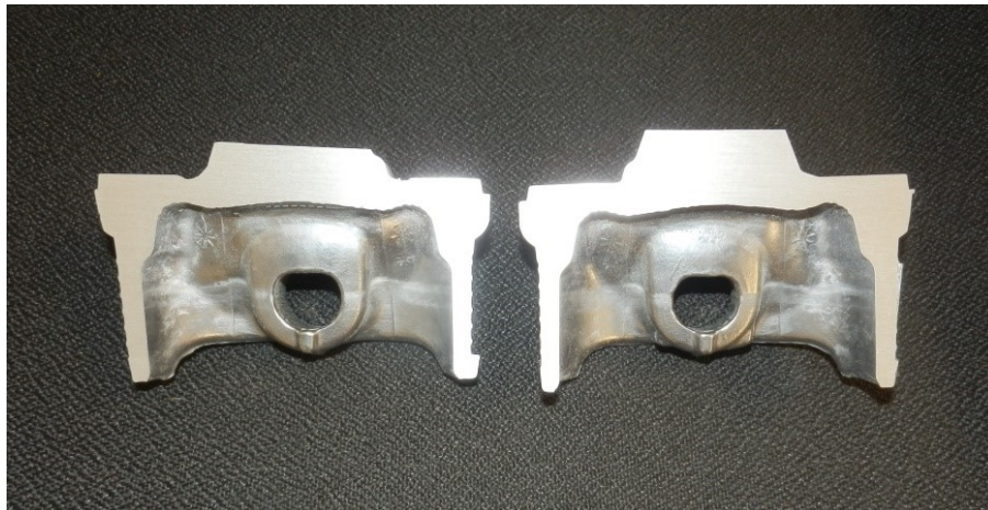
Obr. 3-8 Půlky pístu ze slitiny KS 1295 (AlSi12CuNi2 Mg)
