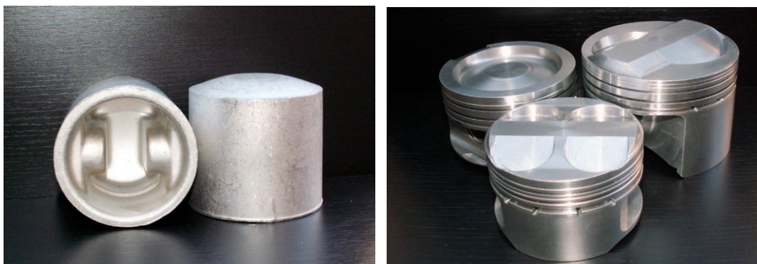
Obr. 2-15 Tvářené polotovary pro výrobu hliníkových pístů (vlevo) a pístů po obrábění (vpravo) [9]
