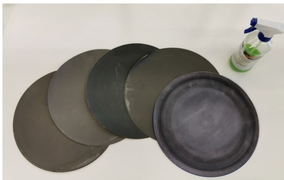
Obr. 3-11 Brusné metalografické kotouče a plstěný kotouč včetně diamantového roztoku
