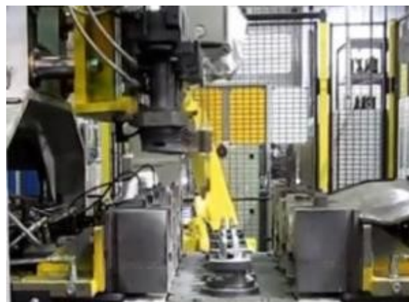
Obr. 2-8 Pohled na stroj pro gravitační lití a otevřenou kovovou formou s kovovými jádry
