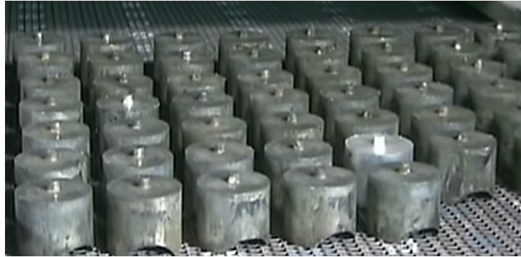
Obr. 2-14 Pohled na tvářené polotovary pístů spalovacích motorů [14]
