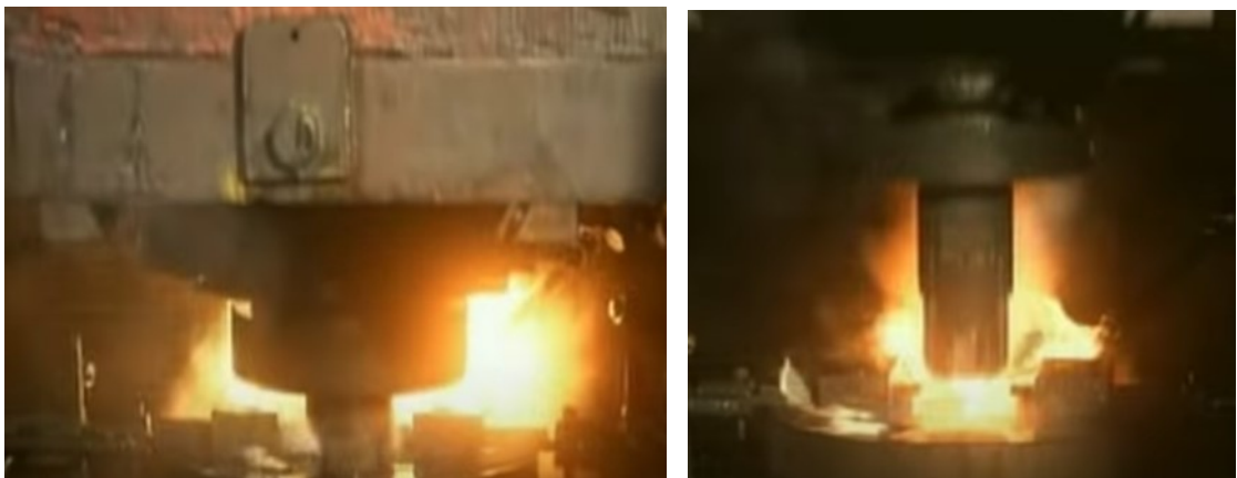
Obr. 2-13 Tváření pístů spalovacích motorů [14]
