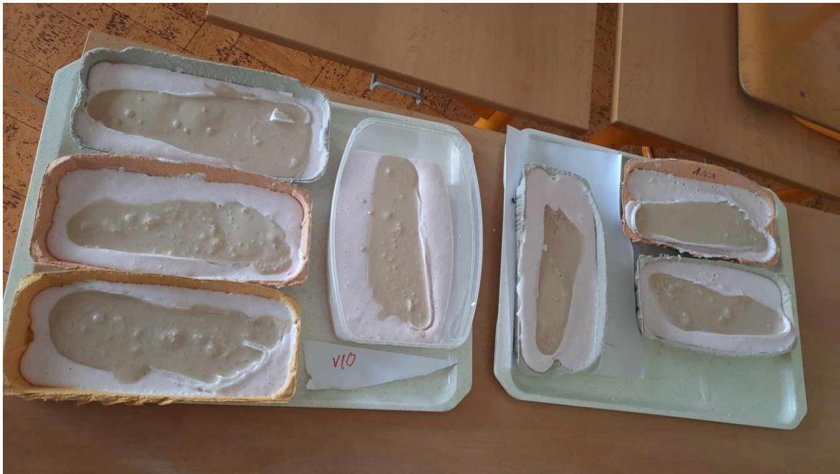
Obrázek 28, Formy naplněné sádkou
