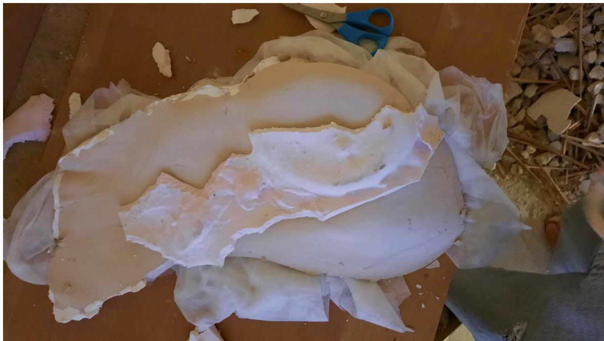
Obrázek 19, Postupné vytahování odlitku z formy
