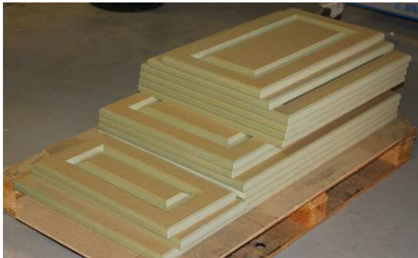
Obr. 19 Ukázka hlubokého frézování do MDF (Zdroj: cncrouting)
