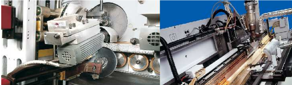
Obr. 26 Detail přitlačných válečků a ohřívacího agregátu (Zdroj:Homag)
