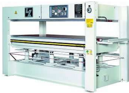
Obr. 9 Jednoetážový lis pro malovýrobu (Zdroj: epimex)
