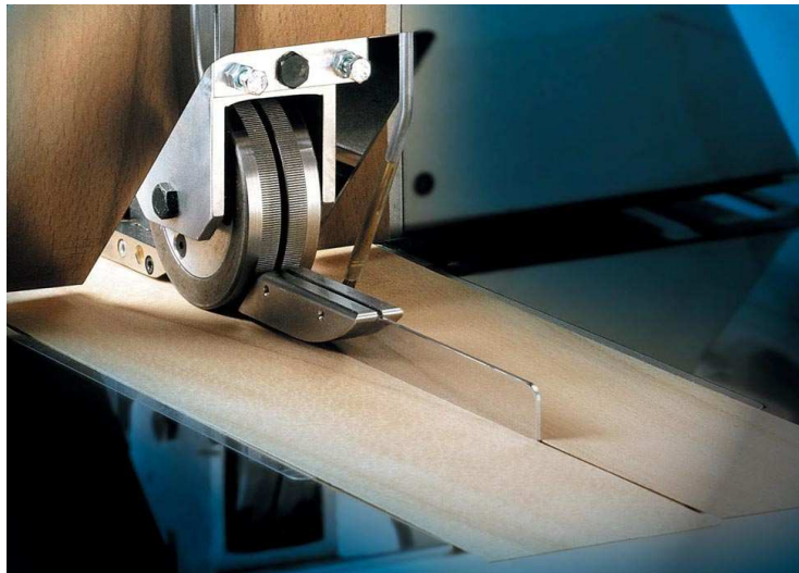
Obr. 6 Detail sesazování dýh "na tupo" (zdroj: plywoodexpress)
