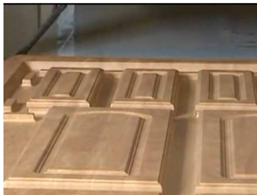
Obr. 20 Pohled na MDF dílce s nanesenou PVC folií před ořezáním přebytků (Zdroj: cabinetdoorskitchen)
