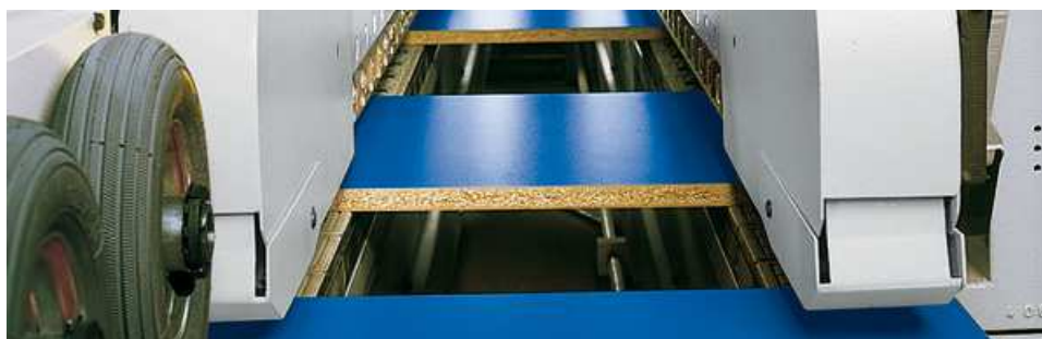
Obr. 11 Průběžná dvojstranná formátovací pila, v tomto případě neořezává dýhu, ale DTD-L (Zdroj: Homag)
