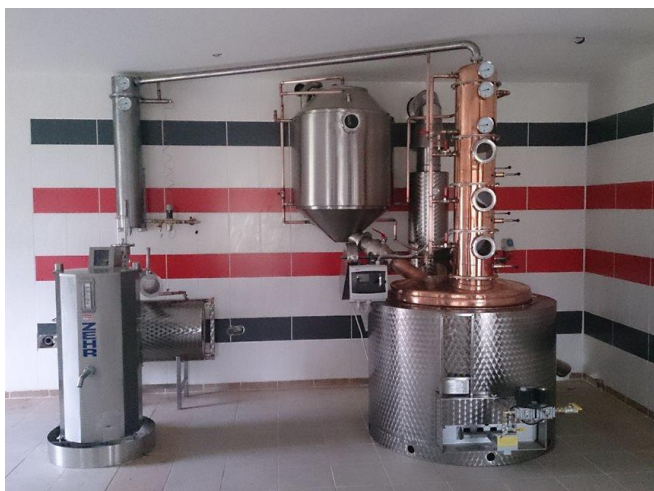
Obr. 10 Jednokotlový systém od firmy Kovoděl Janča
