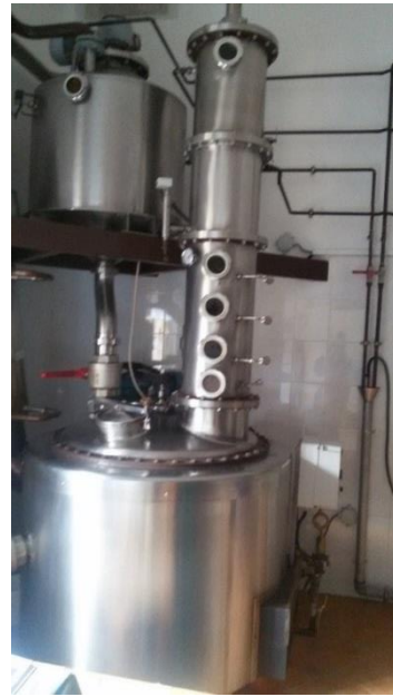
Obr. 12 Destilační kotel s rektifikační kolonou
