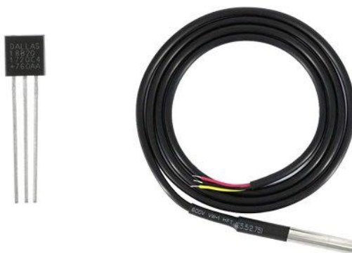
Obrázek 11: Typy senzorů DS18B20.[10]
