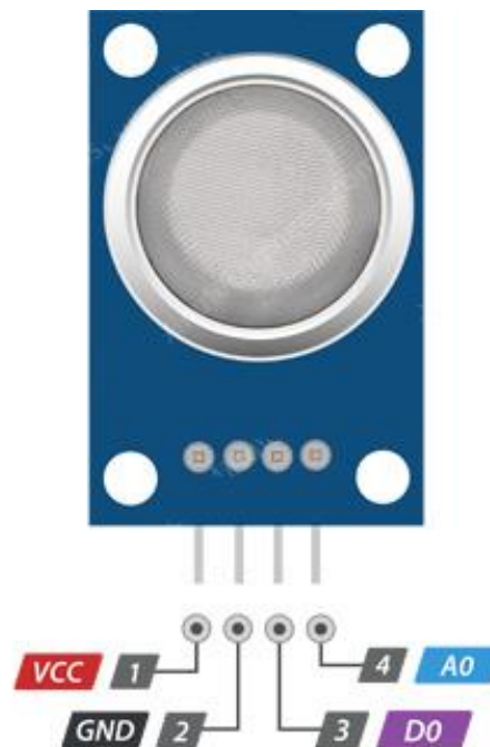
Obrázek 7: Pinování modulu snímače plynu MQ-2.[6]
