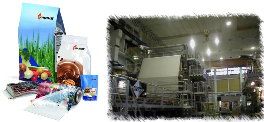
Obrázek 4.3: Ukázka papírenského stroje a produktů MG papíru
