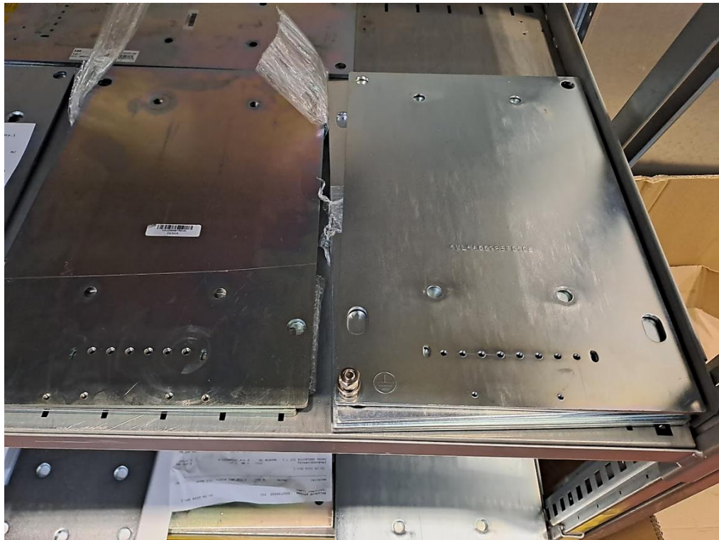
Obrázek 30 Nerezová deska vlevo a pozinkovaná deska vpravo (vlastní zdroj)
