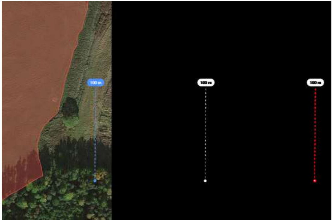
Obrázek 6.4: Binarizace obrazu pro získání referenční vzdálenosti
