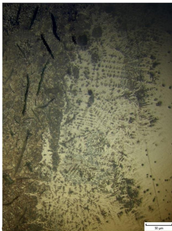
Obr. 77 – Rozhraní Svarový kov a TOO. Zvětšeno 400x
