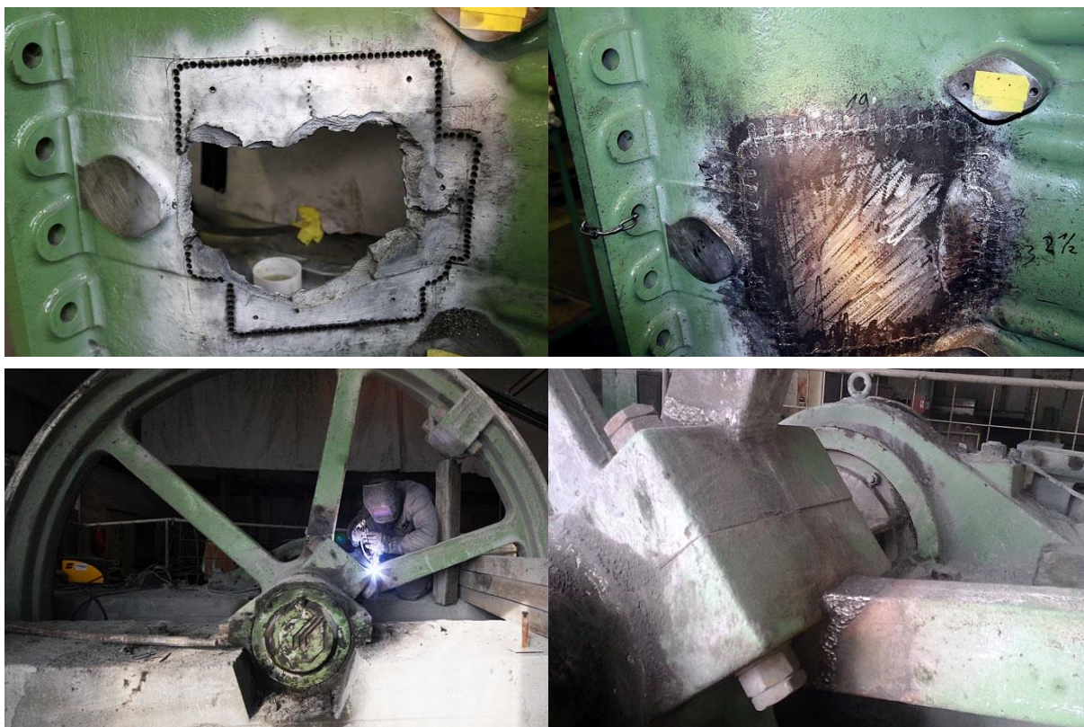
Obr. 1 – Různé metody oprav litinových odlitků [4], [5]
