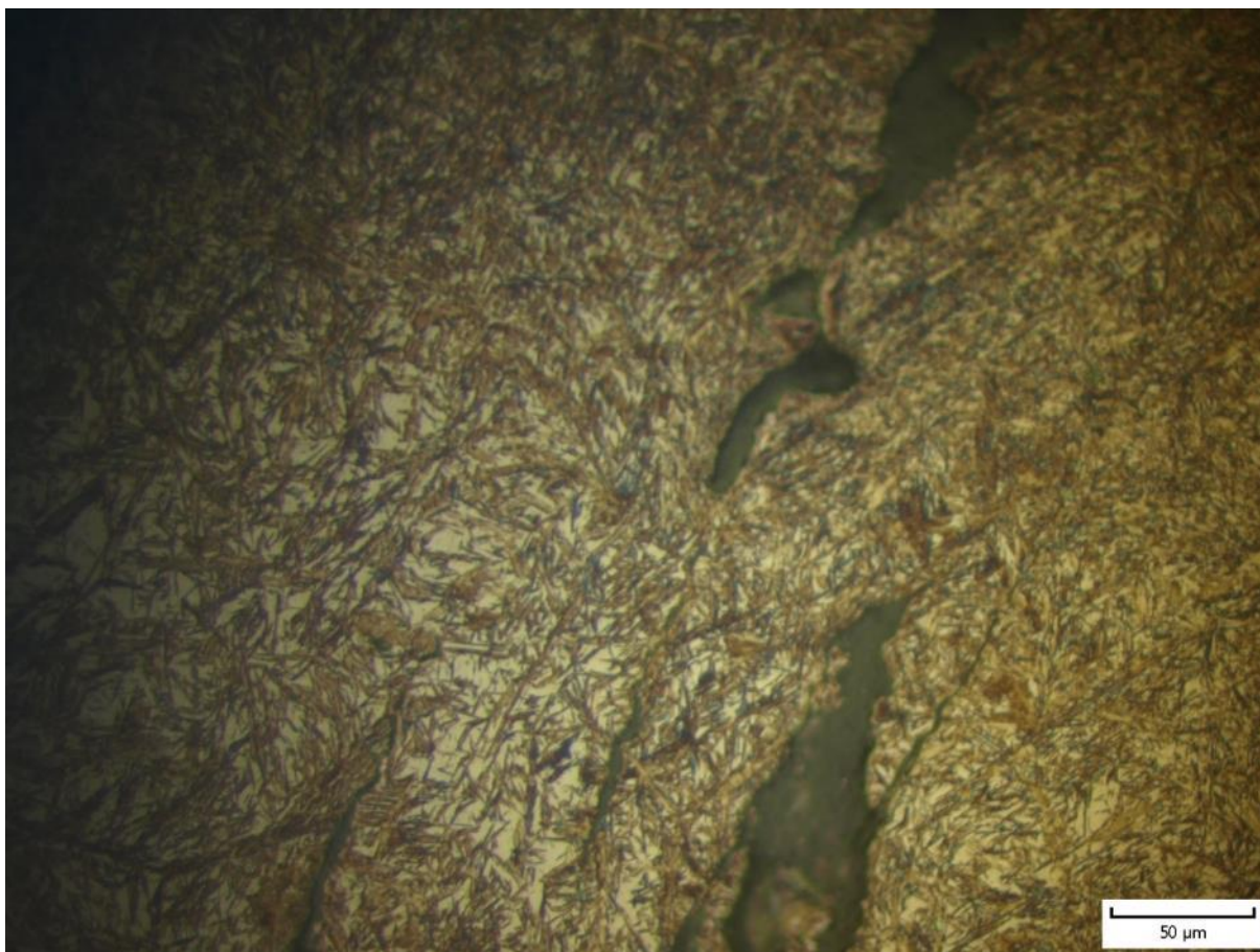
Struktura přechodové oblasti svarového kovu. Zvětšeno 400x
