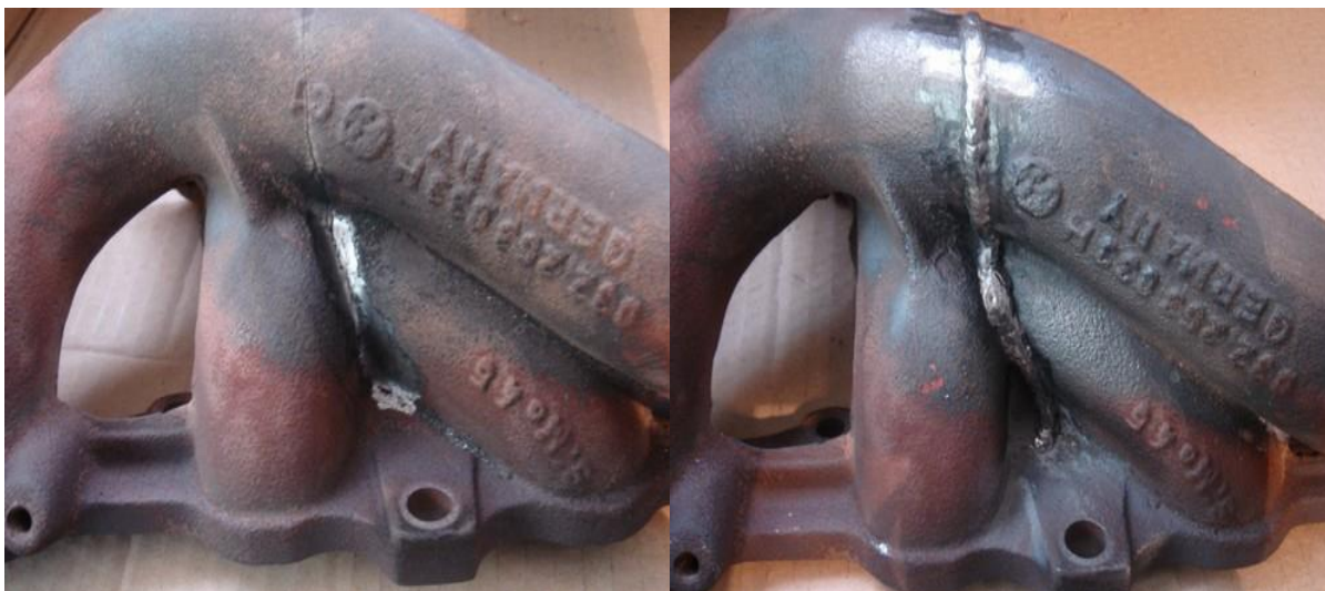
Obr. 12 – Oprava prasklé litinové součásti [17]
