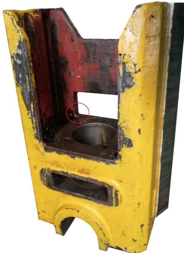
Obr. 4 – Stav beranu po demontáži
