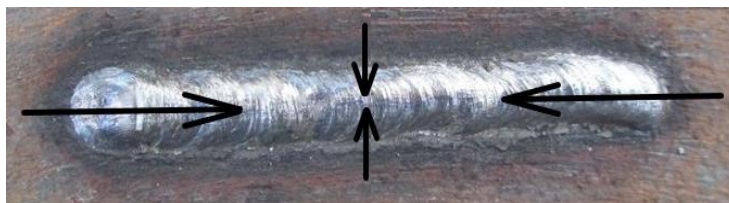
Obr. 52 – Smršťování svarové housenky
