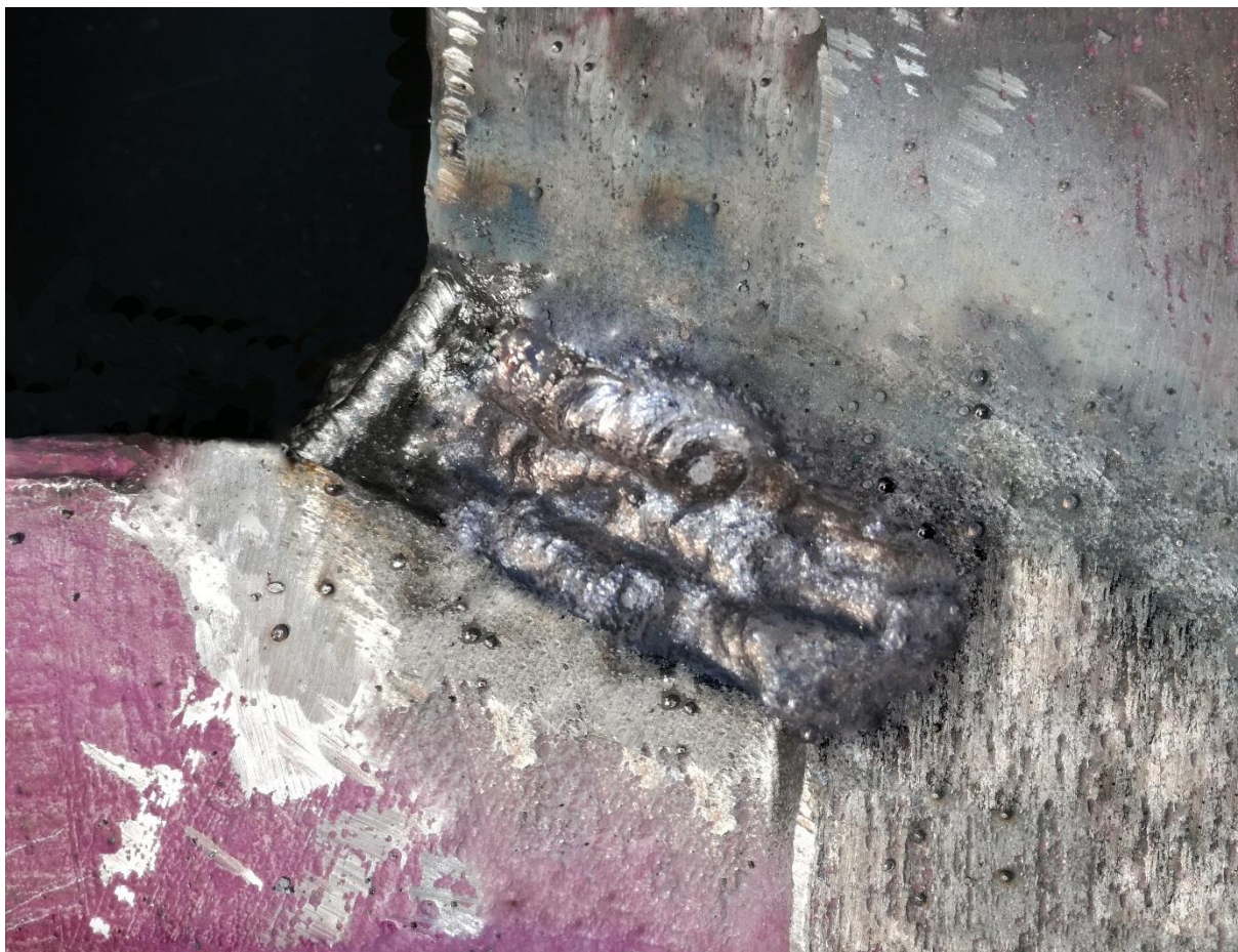
Pohled z vnější strany beranu. Předposlední vrstva na vnější straně svarového spoje.
