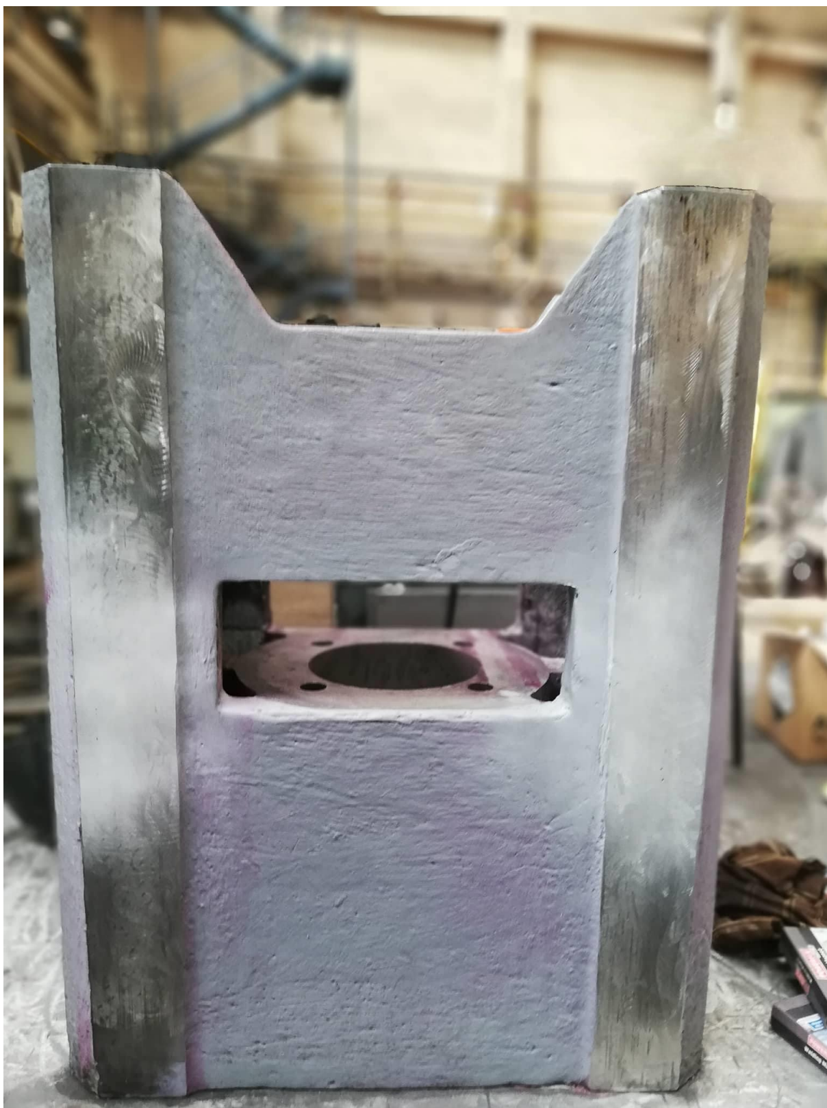
Dokončená oprava prasklého beranu. Pohled na výsledek defektoskopické zkoušky.
