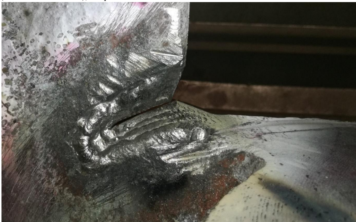
Obr. 92 – První návarová vrstva z vnitřní strany beranu
