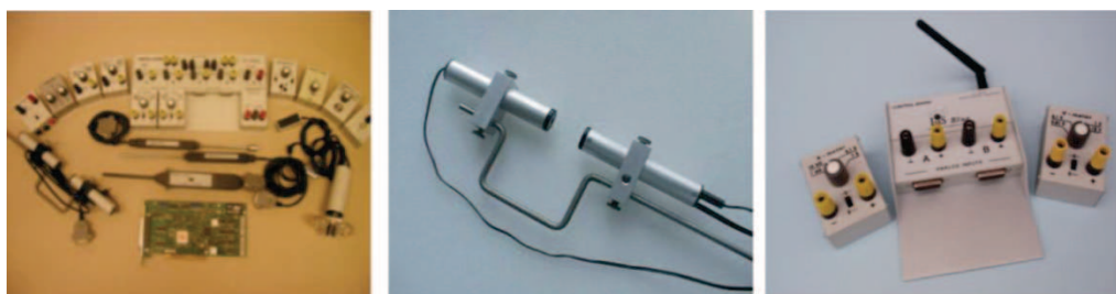
Obr. 2.1 Produkty systému ISES (zleva): sada čidel, měřicí karta a měřicí panel; čidlo optická závora; systém ISES Blue ( http://ises.info ).
