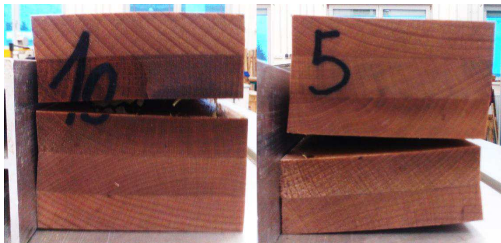
Obr. 43 - Vzorek 10 a vzorek 5 – ukázka rozlepení lamel
