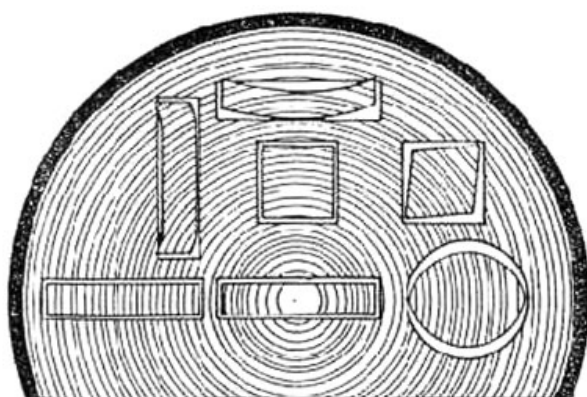
Obr. 4 - Příklad příčného strukturního borcení výřezů rozdílných tvarů z různých míst příčného průřezu kmene (Kollmann, 1951)
