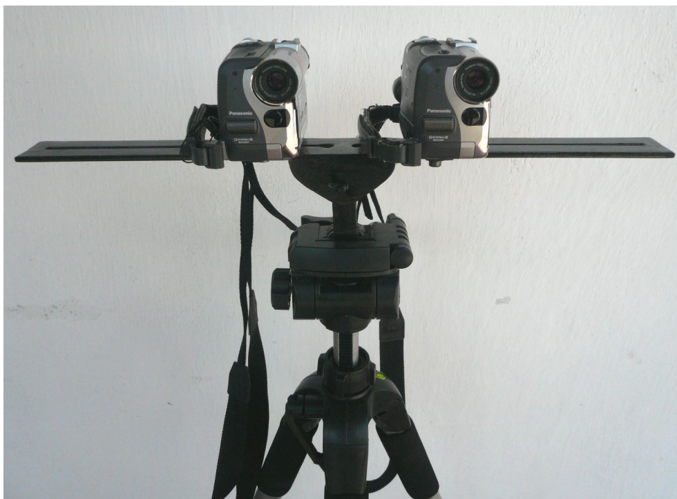
Obr. 21: Navržená snímací aparatura.
