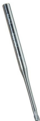
Obr. 4.5 a) stopková fréza \varnothing 1,8 mm, b) dokončení Konstant Z.
