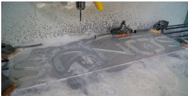
Obr. 4.4 a) stopková fréza \varnothing 4 mm, b) vyhrubování offsetem.
