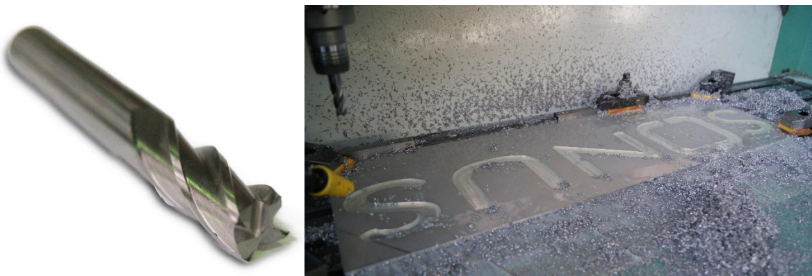
Obr. 4.3 a) stopková fréza \varnothing 10 mm, b) vyhrubování offsetem.
