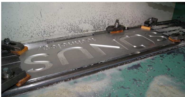
Obr. 4.5 a) stopková fréza \varnothing 1,8 mm, b) dokončení Konstant Z.
