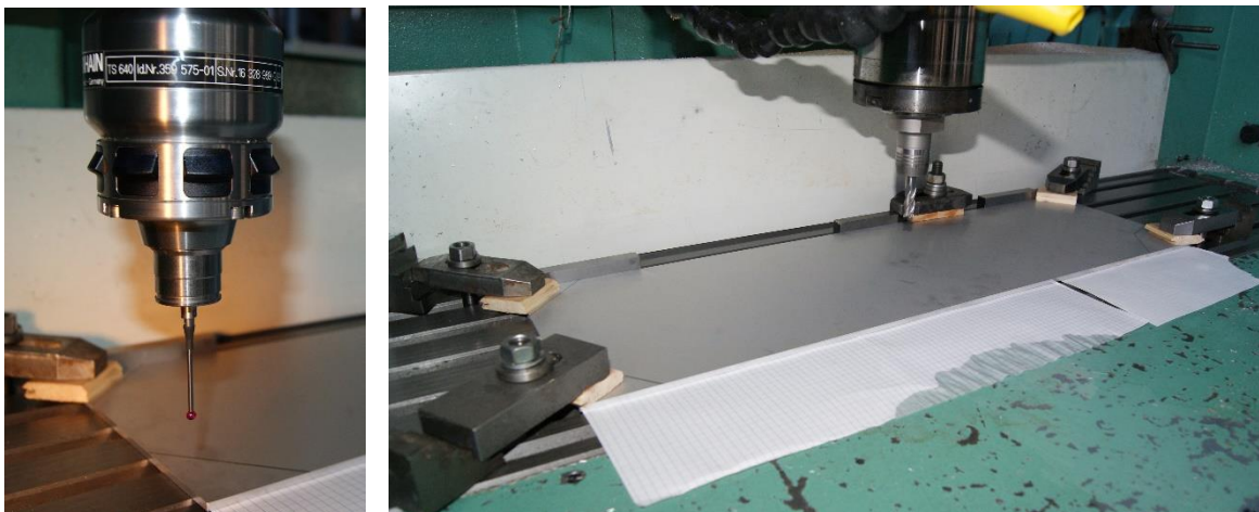
Obr. 4.2 Upnutí obrobku, stanovení nulového bodu a) měřicí sonda, b) upnutí obrobku.
