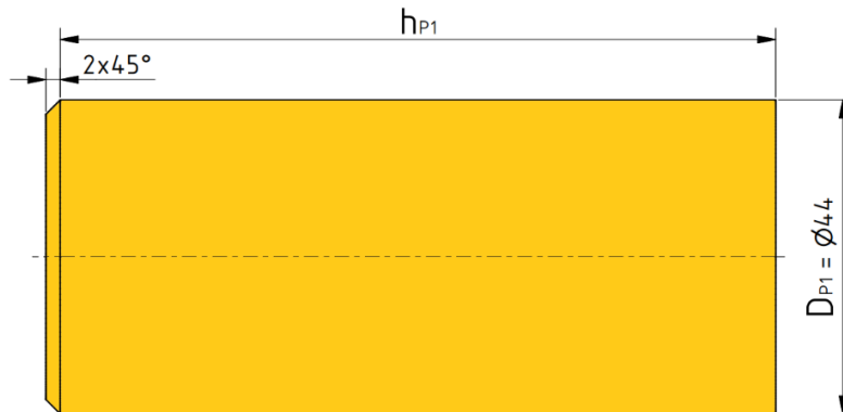
Obr. 51 Rozměry polotovaru v první operaci.
