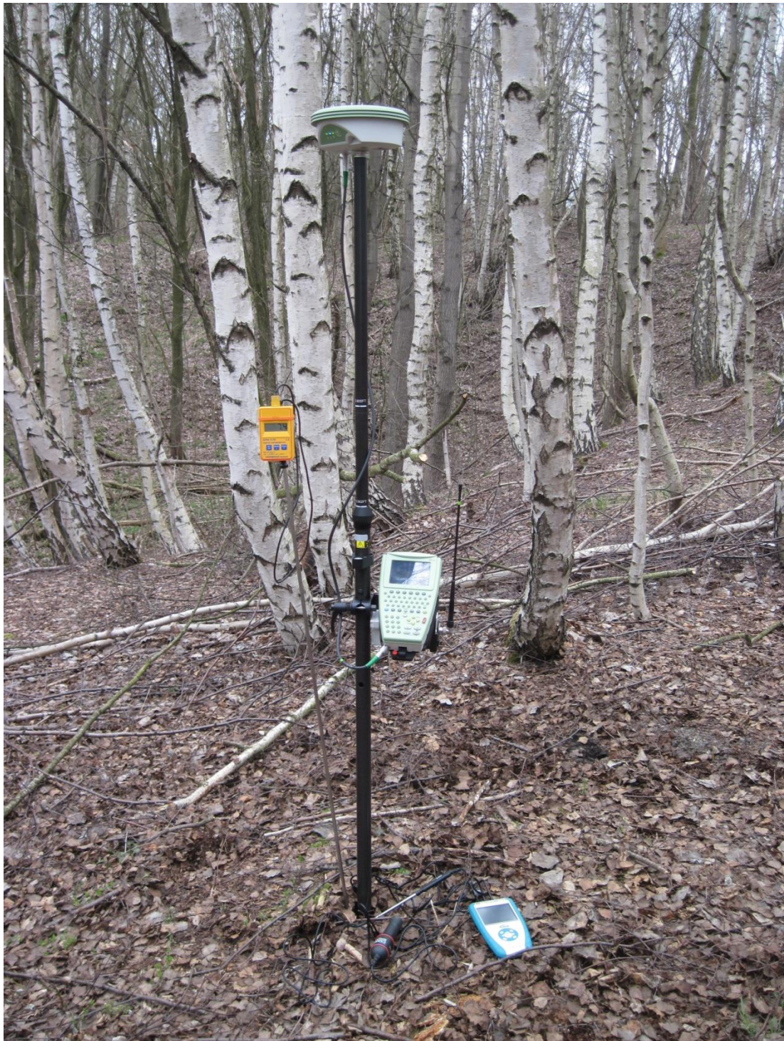
Foto 6: Měření teploty, CO 2 a zaměření GPS Leica - odval Eliška (k.ú. Žacléř)
