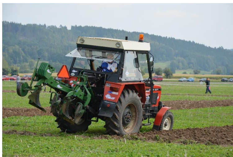
Obrázek 40 - Naklonění pluhu při zahlubování
