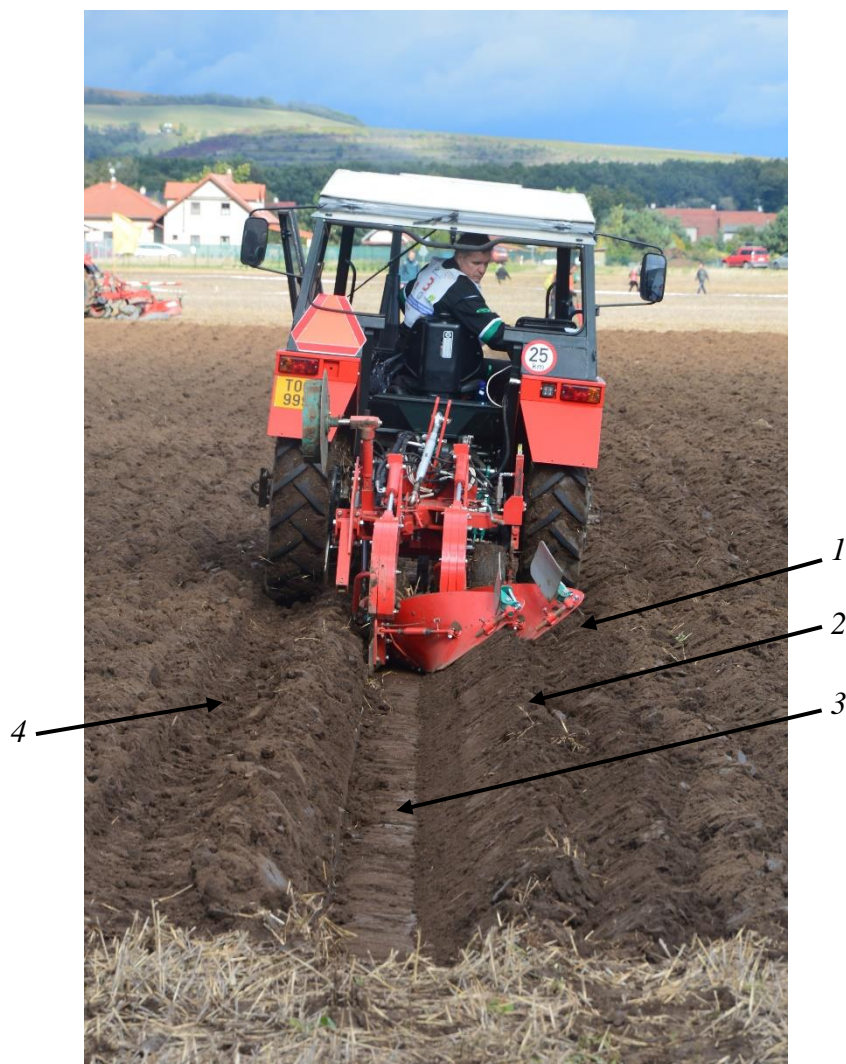
Obrázek 38 - Závěr orby – rozor, 1 – skýva prvního tělesa, 2 – skýva druhého tělesa, 3 – výsledná brázda, 4 – jediná stopa traktoru
