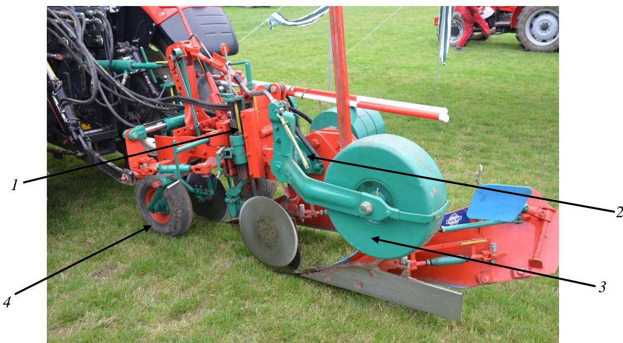
Obrázek 16 - Opěrná kola a měrky, 1 – Měrka pro měření hloubky krojidla, 2 – Měrka pro měření nastavení opěrného kola. 3 – Hlavní opěrné kolo, 4 – pomocné opěrné kolo
