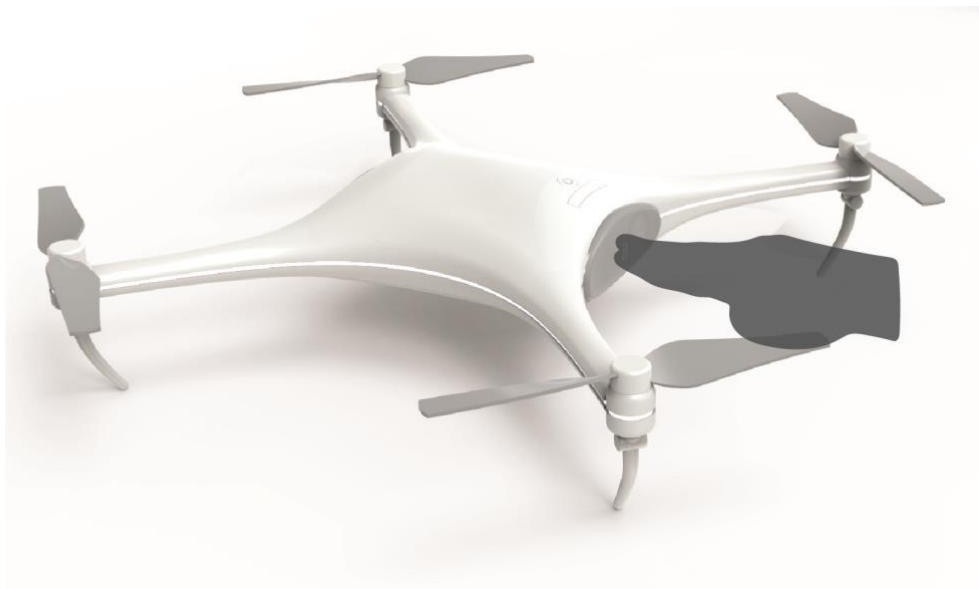
Obr. 6-5 ergonomie výměny baterie – 1. fáze
