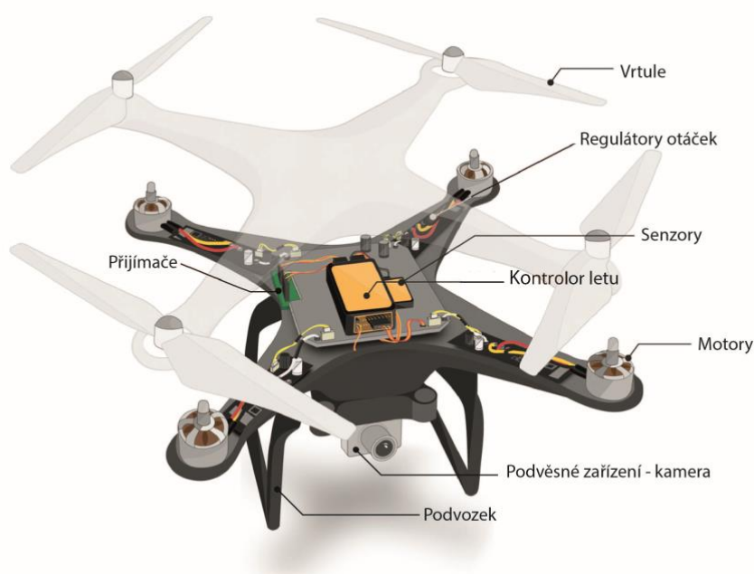
Obr. 2-17 schéma komponent dronu [29] – upraveno autorem
