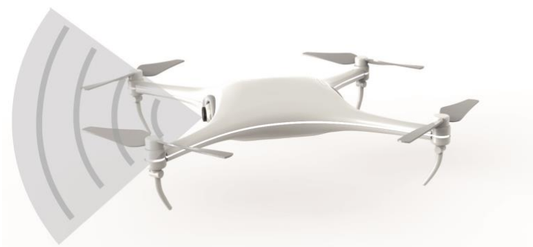
Obr. 6-9 zorné pole kamery – vertikální směr
