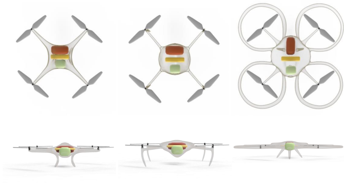
Obr. 4-2 schéma vnitřních komponent variantních návrhů
