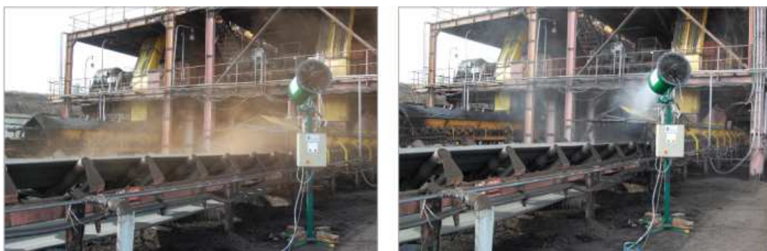
Obr.č. 14 a,b: Srovnání jednoznačně dokazující účinnost zařízení Zdroj: SUAS.cz
