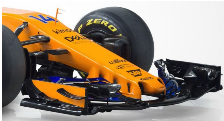
Obrázek 23: Ukázka přitlačného křídla formule F1, vyrobeného z prepregu [67].
