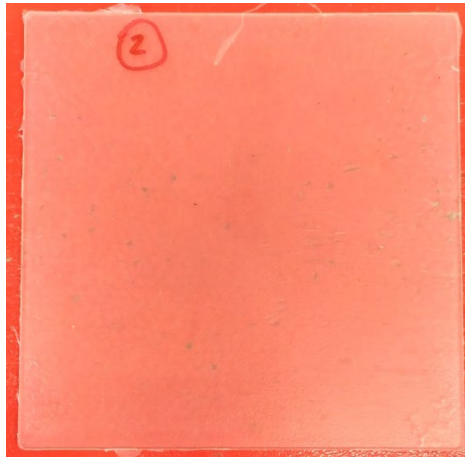
Obrázek 42: PLA destička bez bublin a propadlin v krajích destičky
