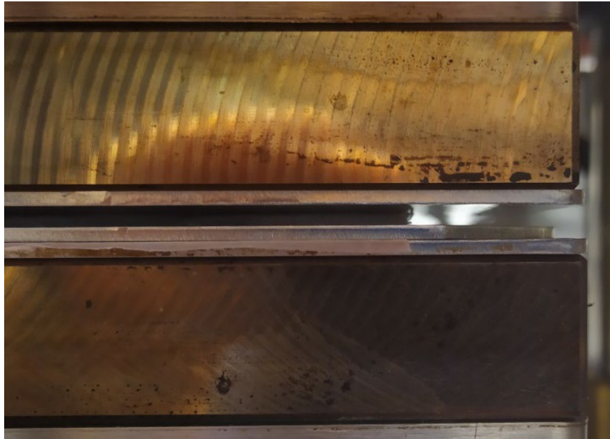
Obrázek 44: Ukázka měknutí PLA granulátu v době předehřevu
