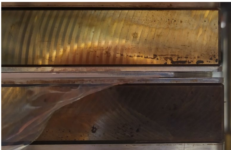
Obrázek 45: Proces lisování - dochází k vytvoření přetoku PLA ven z formy
