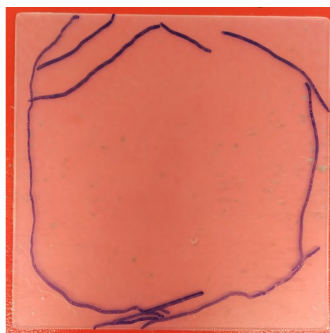
Obrázek 41: PLA destička bez bublin, po krajích destičky jsou zřejmé propadliny
