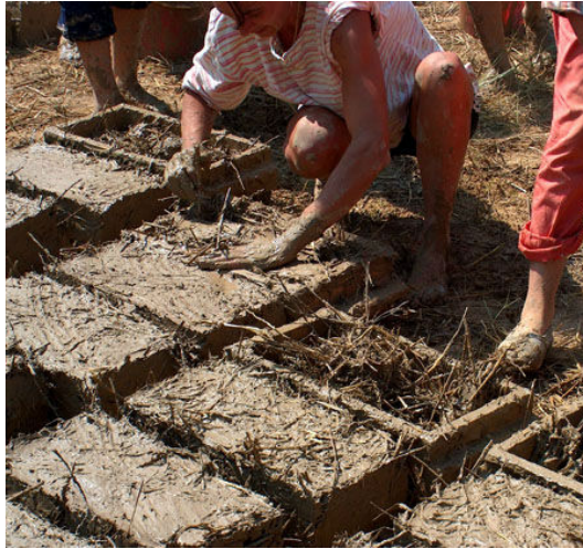
Obrázek 1: Výroba cihel ze slámy s jílu způsobem, známým od středověku [4]
