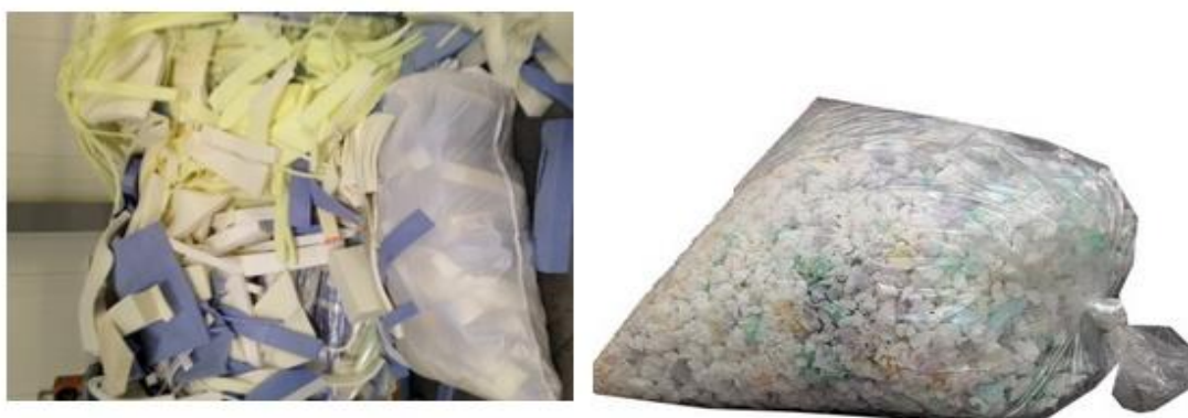
Obrázok 13. Ukážka molitanového odpadu a molitanovej drte Zdroj: Matratex manufacture s.r.o a http://www.naradi.org/
