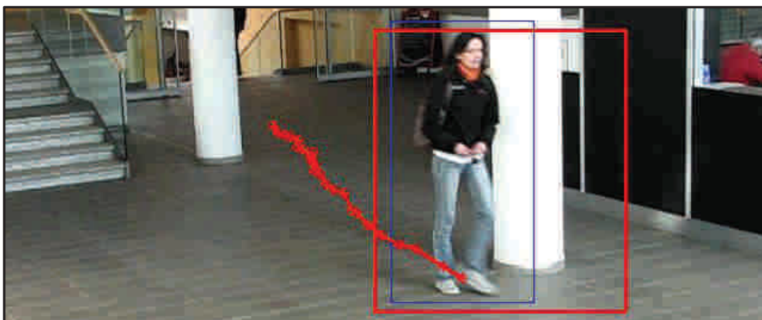
Obr. 2.9: Zvětšená oblast pro porovnávání se vzorem s trajektorií pohybu (červená). Výstup Kalmanova filtru (modrá).
