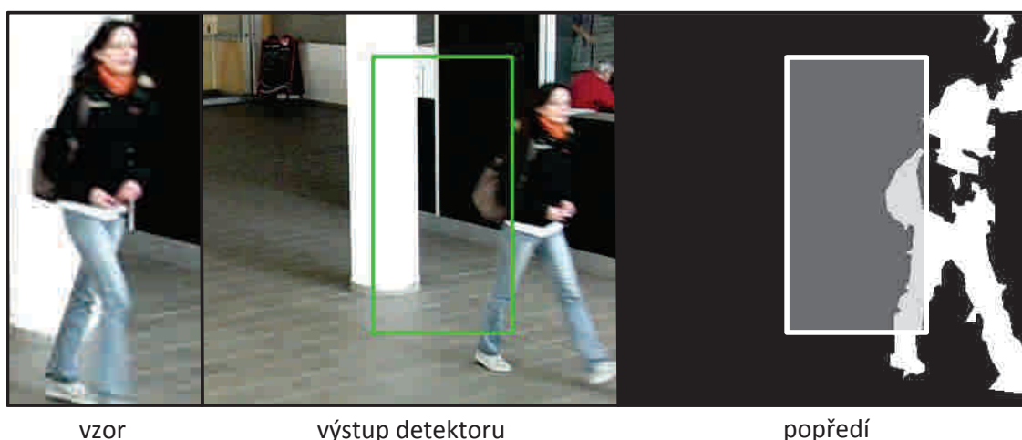
Obr. 2.11: Selhání detektoru při porovnávání se vzorem.
