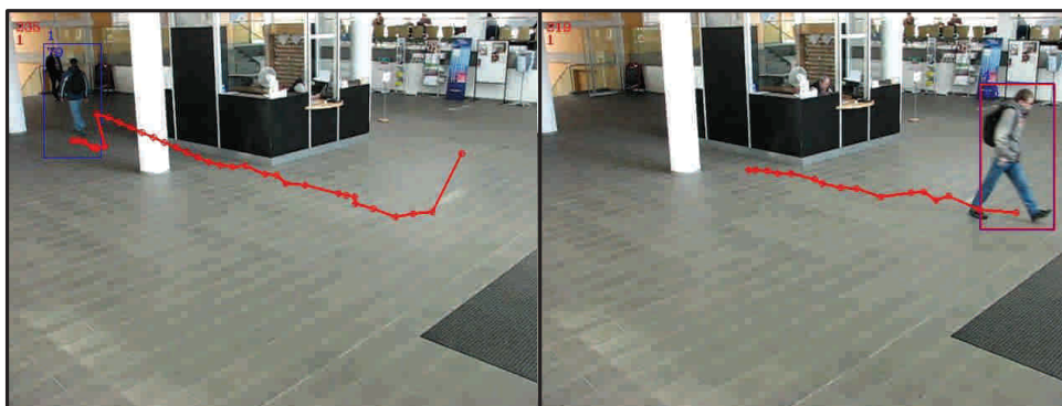
Obr. 5.2: Selhání detektoru pro postavy menší jak mezní velikost.
