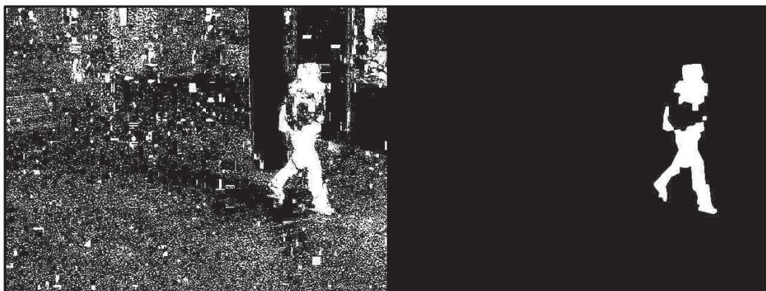
Obr. 2.12: Obrázek špatně segmentovaného popředí vlevo s provedením morfologických operací vpravo.
