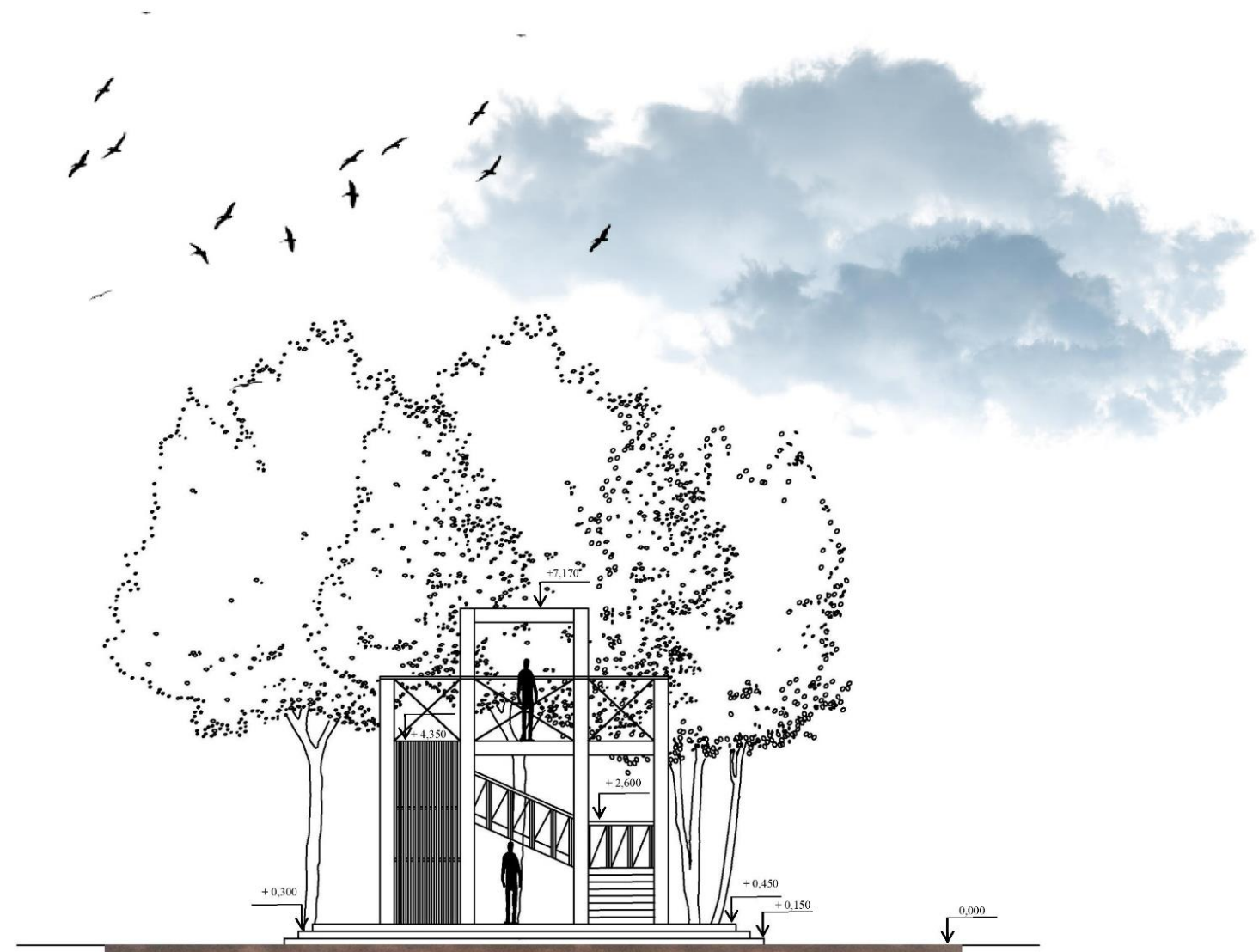
Obrázek 126: Řezopohled rozhledny. 1:50. Zdroj: autor
