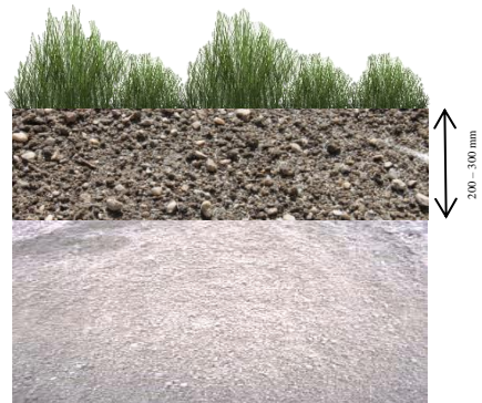
Obrázek 121: Štěrkový trávník řez. Zdroj: autor.
