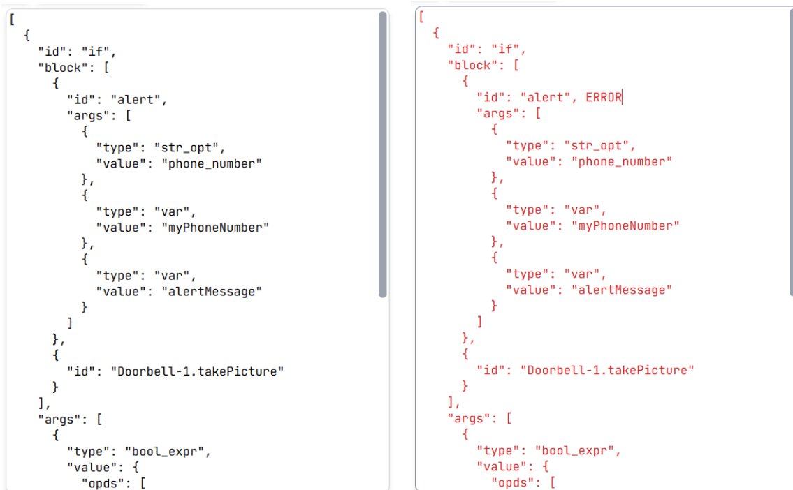
Obrázek 6.5: Ukázka výsledného programu v textovém pohledu. Na levé straně je korektní verze programu. Na pravé straně je verze programu se syntaktickou chybou. Na tuto chybu je uživatel vizuálně upozorněn změnou barvy textu.
