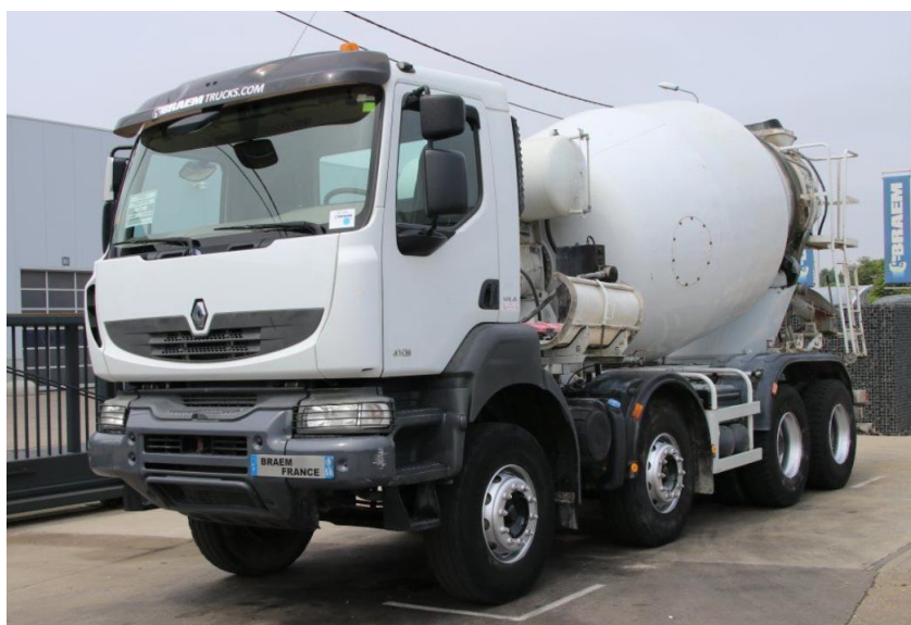
Obrázek 90: Autodomíchávač Renault Karax 410 objem bubnu 8 m 3 [ 20 ]
