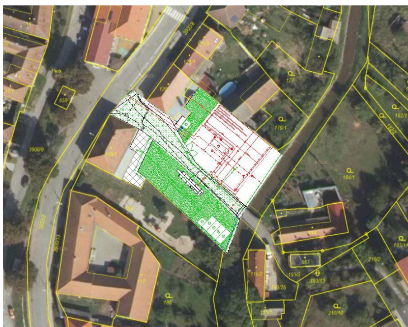
Obrázek 123: Letecký snímek s vloženou situací zařízení staveniště [ 2 ]
