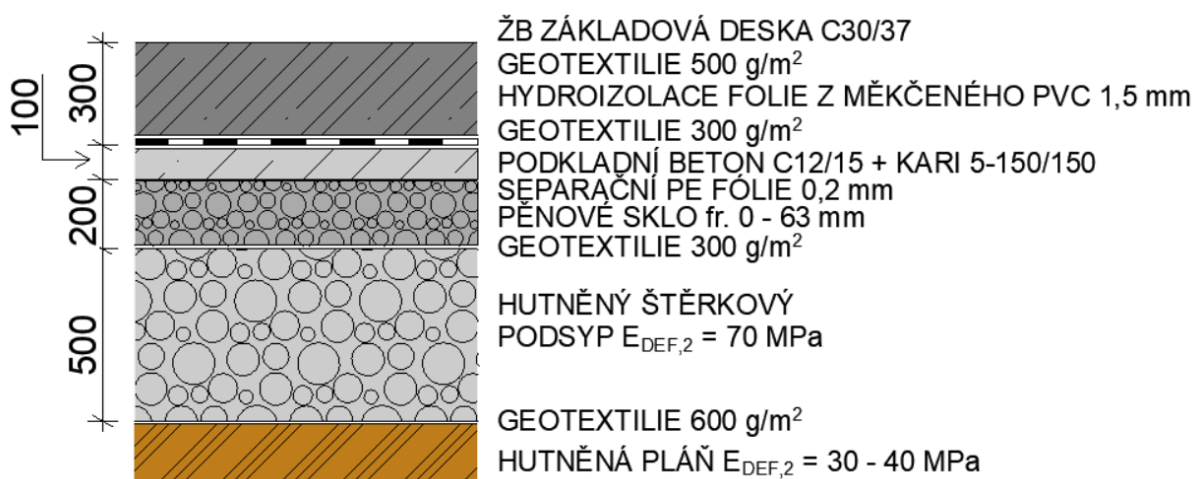
Obrázek 108: Skladba podkladních vrstev hrubé spodní stavby
