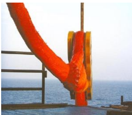
Lano k ukotvení ropné plošiny v Mexickém zálivu, průměr 28 cm. 1
