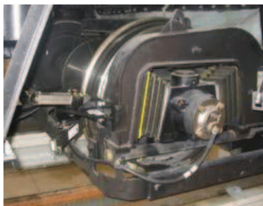
Obr. 2.13 Mazací jednotka na vozidle [8]
