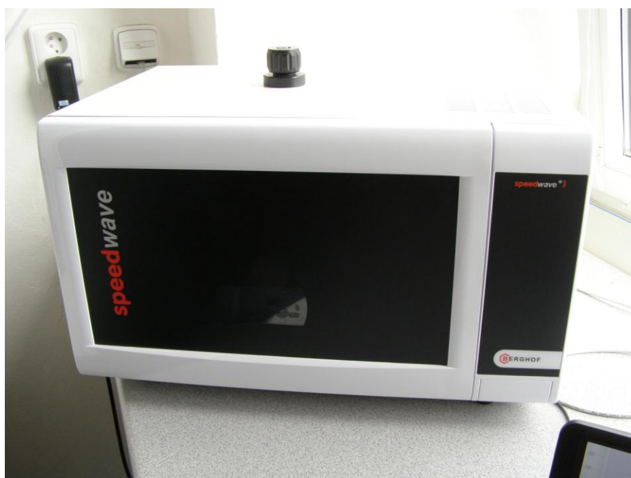
Mikrovlnné mineralizační zařízení speedwave® two od firmy Berghof
