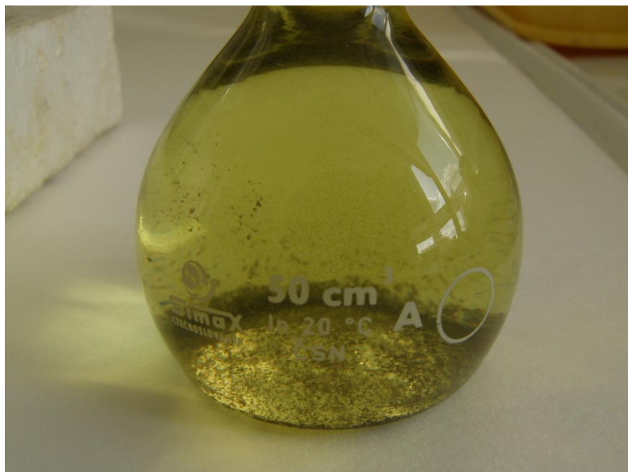
Zmineralizovaný vzorek naředěný destilovanou vodou
