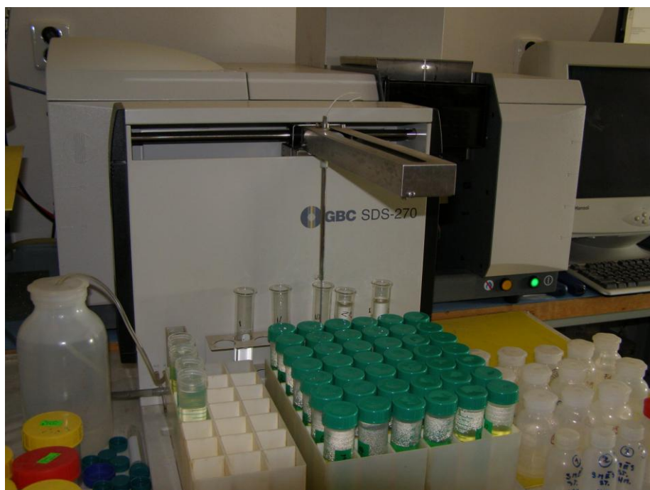
Atomový absorpční spektrometr Avanta \Sigma s automatickým podavačem SDS-270 od firmy GBS
