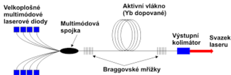
Obr. 23 – Schéma vláknového laseru [17]
