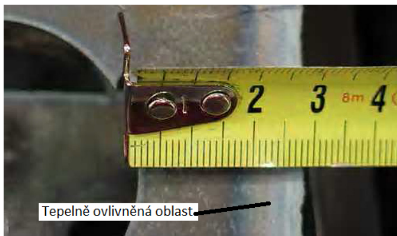
Obr. 7 – Zobrazení tepelně ovlivněné oblasti na součásti
