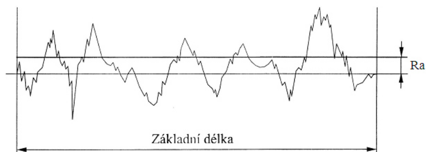
Obr. 31 – Zobrazení výpočtu aritmetické úchylky profilu Ra [19]
