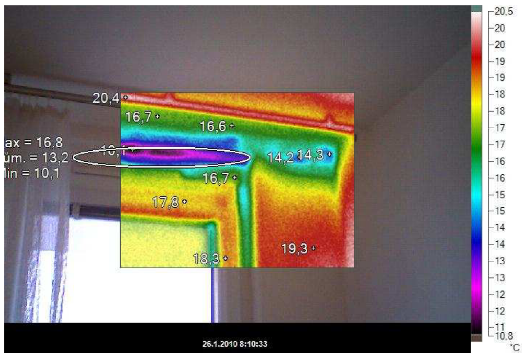
Obrázek 6.1 – 2b) - Tepelný most v místě překlady, rozdíl teplot 9,2°C [13]
