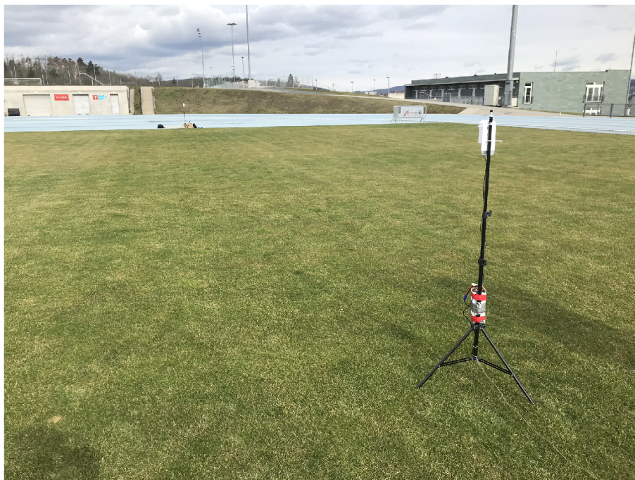
Obr. A.3: Měření vysílacího výkonu v závislosti na vzdálenosti
