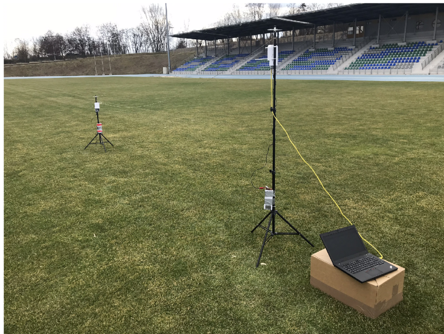
Obr. A.2: Měření vysílacího výkonu v závislosti na úhlu - vertikální
