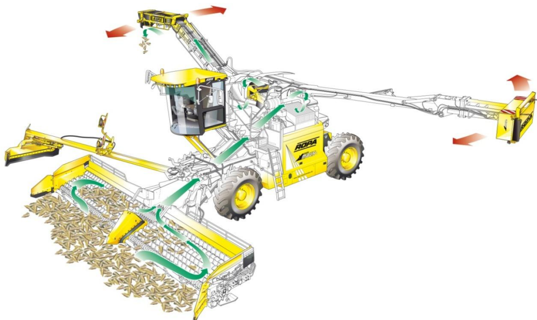
Obr. 3.5: Samojízdný čistící nakladač ROPA euro-Maus 4 (Zdroj: https://www.ropa-maschinenbau.de )
