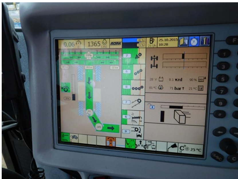
Obr. 4.3: Zobrazené základní nastavení otáček čistících válců. Hodnoty 7, 6 a 8 byly měněny o 2 stupně nahoru a dolů. Stupnice nastavení je v rozmezí 1 až 10
