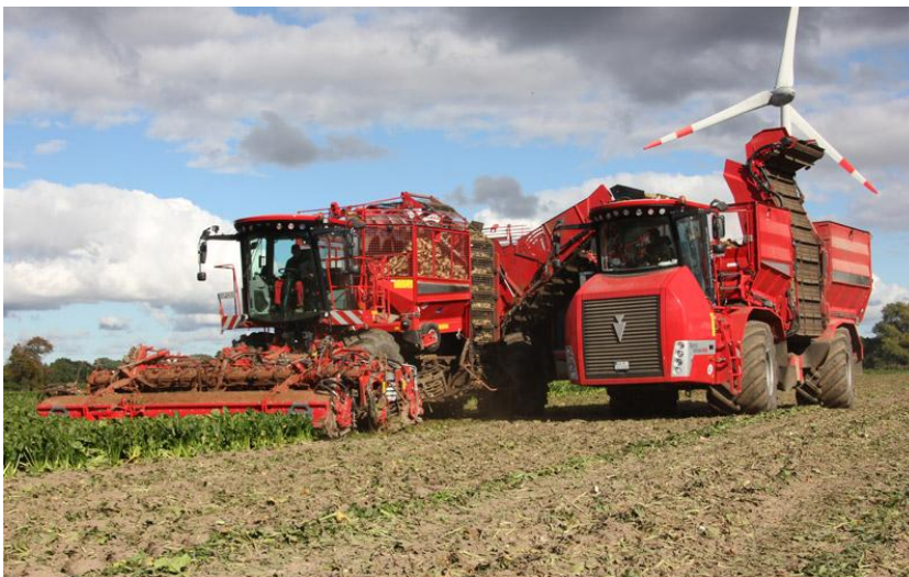
Obr. 2.3: Překládání bulev ze sklizeče do vyvázečního stroje za jízdy (Zdroj: www.holmer-maschinenbau.de )
