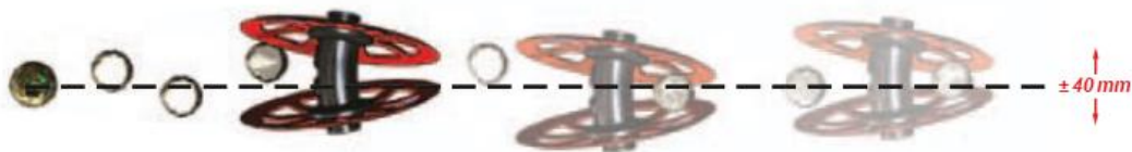
Obr. 2.16: Navádění rotačního vyorávacího ústrojí (Zdroj: www.grimme.de )
