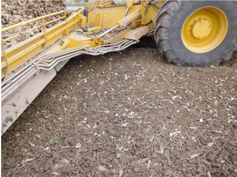
Obr. 4.7: Ztráty pozorovatelné za příjmovým stolem
