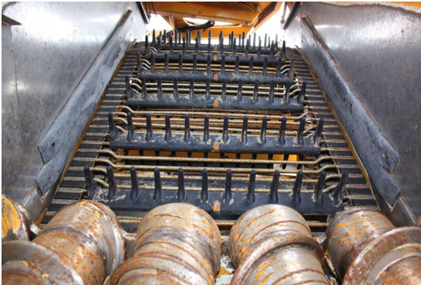
Obr. 3.9: Část prutového dopravníku s hrabicemi (Zdroj: www.grimme.com/de/media )
