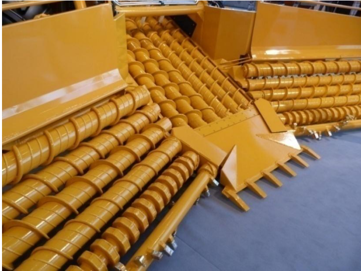
Obr. 3.7: Příjmový stůl stroje Kleine, doprava a čištění bulev středem stroje je řešena podélně uloženými válci se šroubovicí na povrchu
