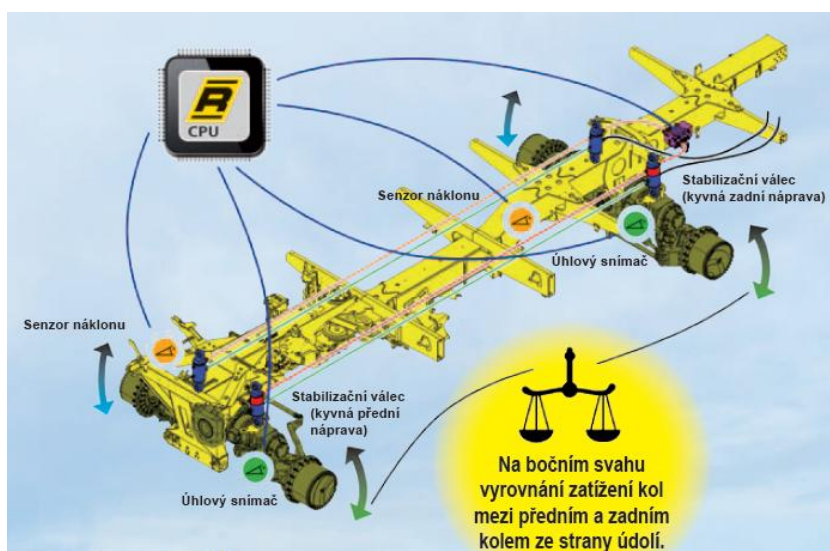
Obr. 2.19: Automatické vyrovnávání na svahu (Zdroj: www.dagros.cz )
