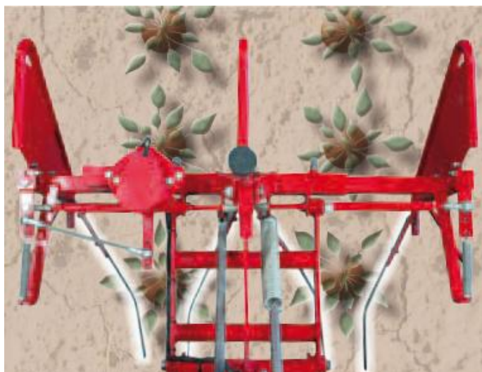
Obr. 2.15: Hmatače chrástu zajišťují přesné vedení stroje (Zdroj: www.agrifac.com )
