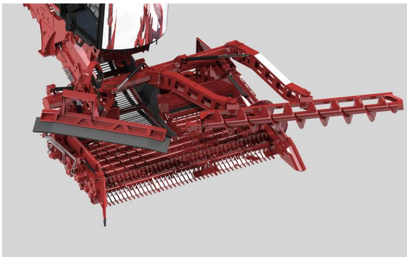
Obr. 3.18: Příjmový stůl stroje Holmer Exxact pro nakládku ze zpevněných i nezpevněných ploch (Zdroj: www.holmer-maschinenbau.de )
