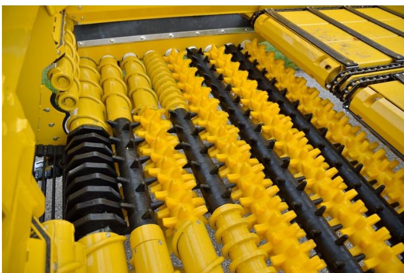
Obr. 3.4: Rotační rošty kovové a pryžové u košového čistícího nakladače Ropa (Zdroj: https://www.ropa-maschinenbau.de )
