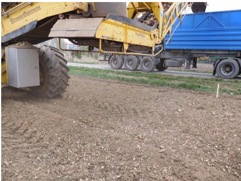
Obr. 4.8: Ztráty pozorovatelné za prutovým dopravníkem
