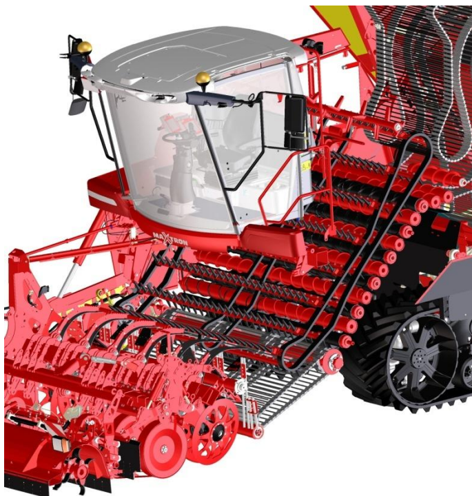
Obr. 2.27: Čistící dráha sklizeče Grimme Maxtron 620 (Zdroj: www.grimme.com/de/media )
