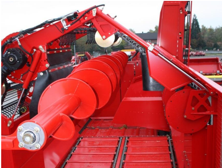
Obr. 2.13: Rozhrnovací šnek v zásobníku, nad ním okružní elevátor (Zdroj: www.grimme.com/de/media )
