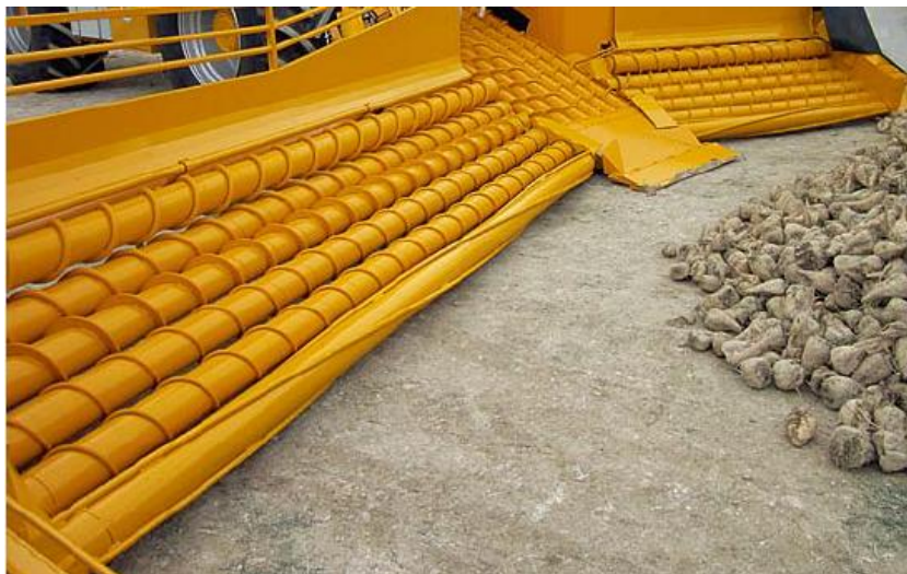
Obr. 3.17: Příjmový stůl stroje Kleine pro nakládku ze zpevněných ploch (Zdroj: www.grimme.com/de/media )
