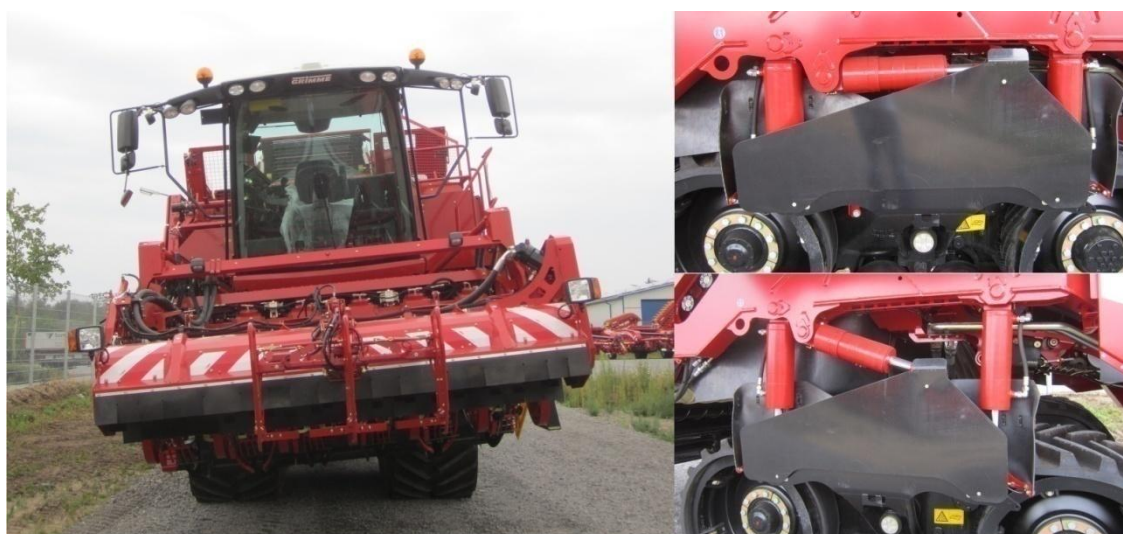
Obr. 2.28: Svahové vyrovnávání naklápěním polopásového podvozku (Zdroj: www.grimme.com/de/media )
