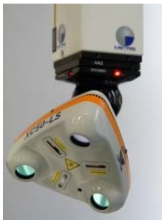
Obr. 2.5 Křížový skener XC50 23
