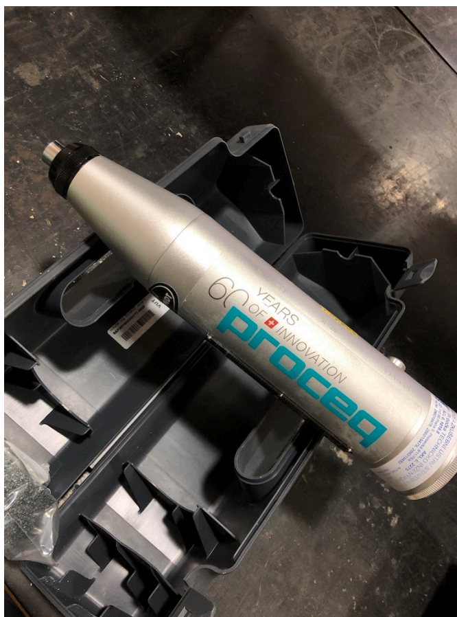
Obrázek 28 Odrazový tvrdoměr Schmidt N
