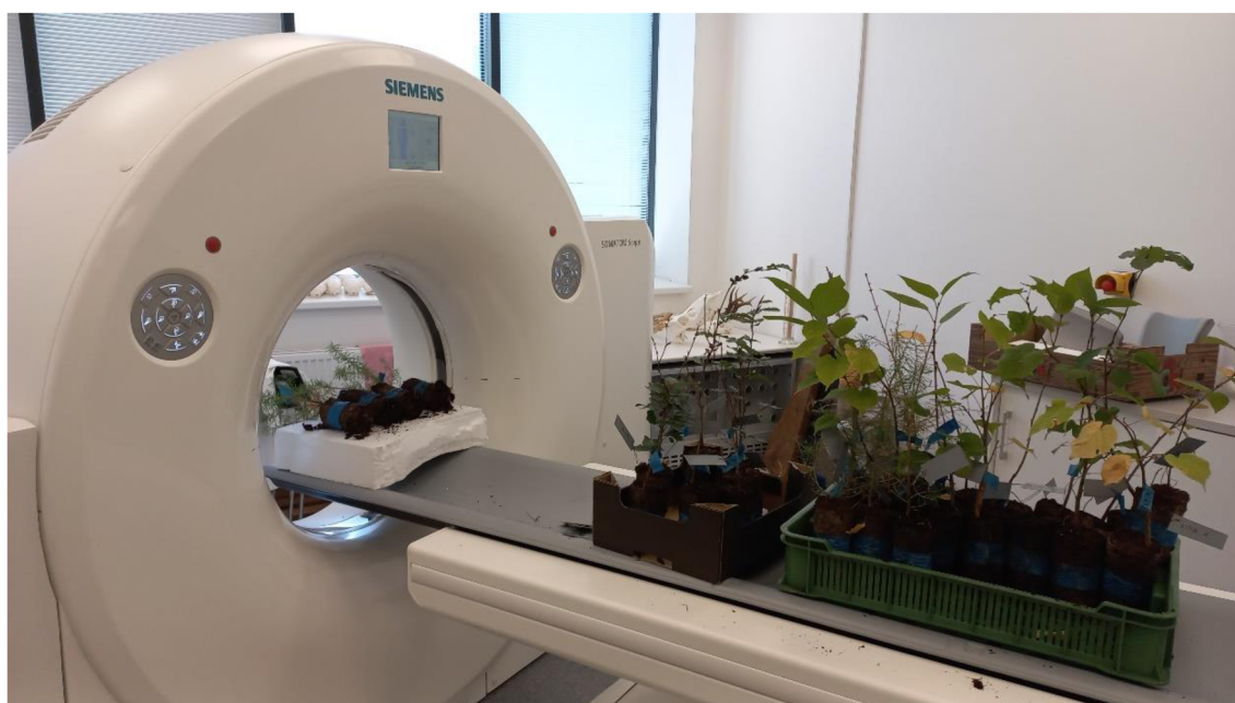
Obr. 7: Snímání sadebního materiálu na multidetektorovém výpočetním tomografu Siemens Somatom Scope Power.
