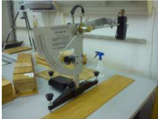
Obr. 9: Skid-resistance tester s třecím kyvadlem (Culka – vlastní foto 2014).
