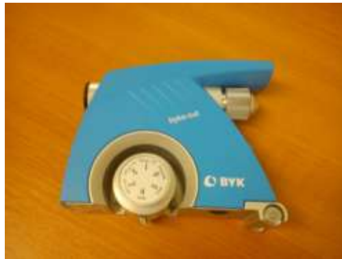
Obr. 6: Byko-cut universal 3430 (Culka – vlastní foto 2014).
