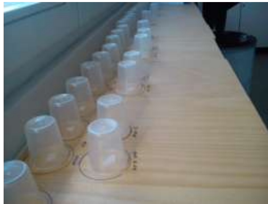
Obr. 17: Zkouška odolnosti proti kosmetickým přípravkům při pokojové teplotě (Culka – vlastní foto 2014).
